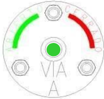
Figura 16. Mirilla de posición de indicador interno.
