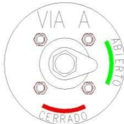
Figura 17. Indicador de posición externo.
