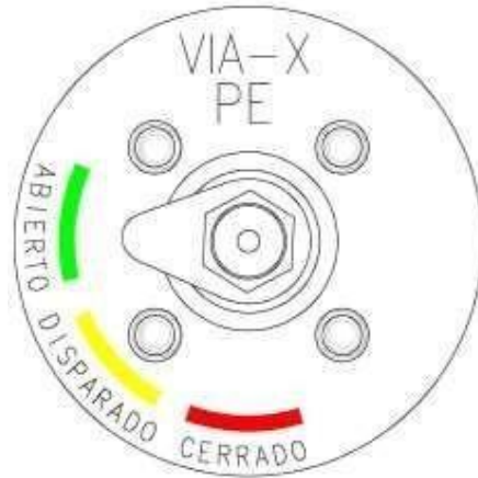
Figura 18. Indicador para vías que cuentan con protección electrónica.
