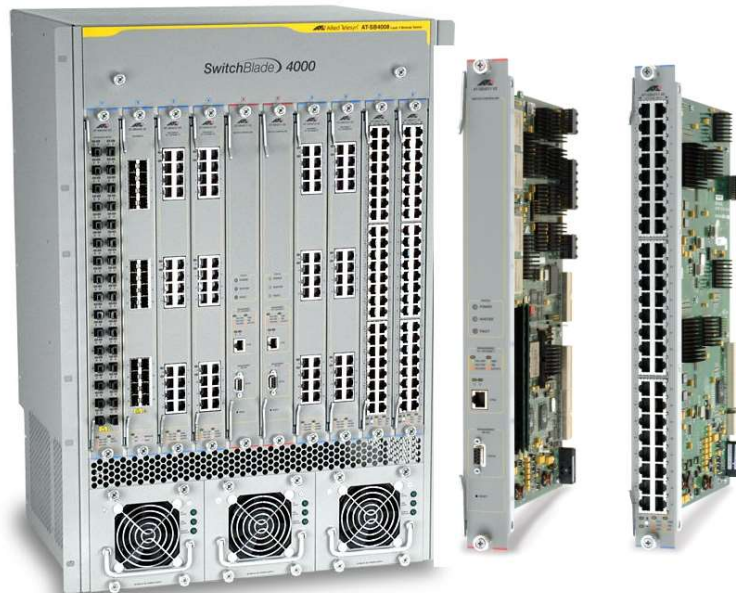
Figura 3.33. Switch troncal de altas prestaciones
