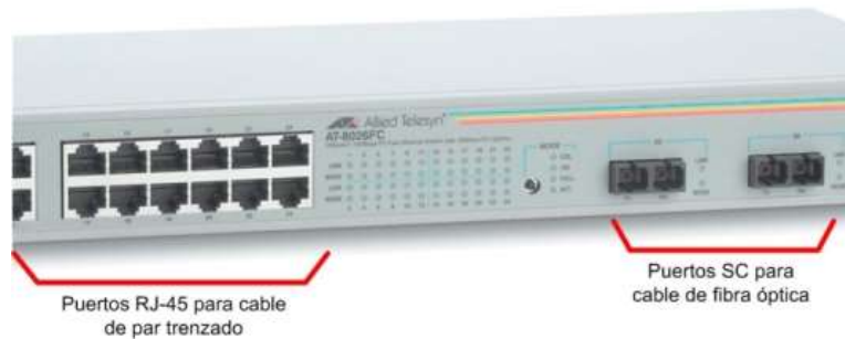
Figura 3.22. Switch con puertos RJ-45 y SC
