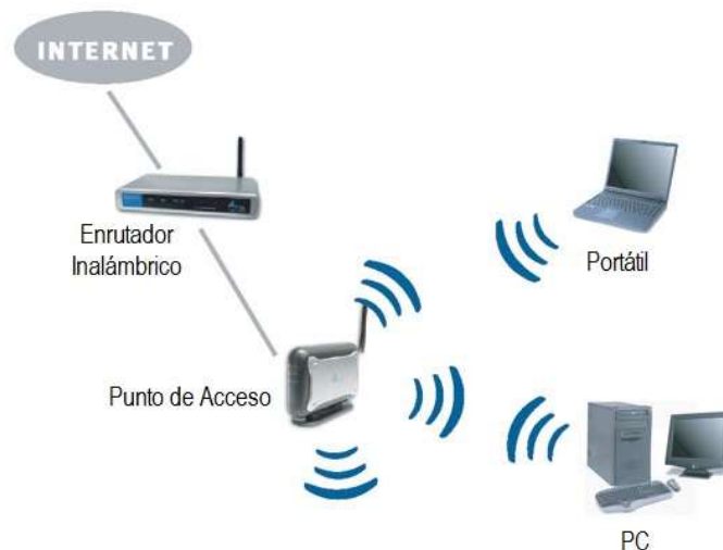
Figura 3.40. Funcionamiento de un Access Point
