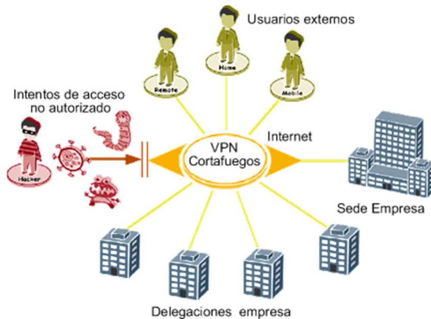
Figura 3.45. Funcionamiento de una VPN
