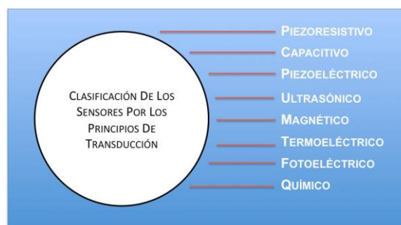
Figura 19 Sensores según el Principio de Transducción
