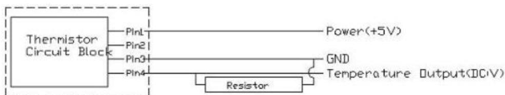
Figura 48 Configuración para Medir Temperatura
