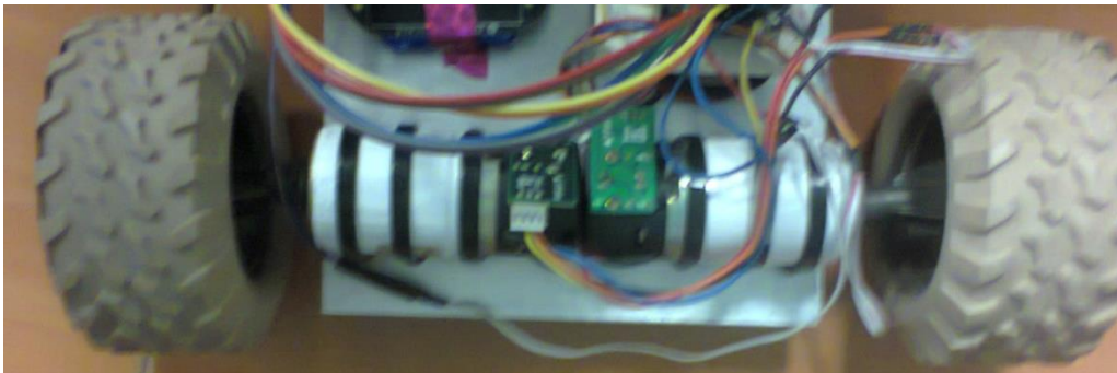
Figura 4. 3 Colocación de motores sobre una placa de Aluminio para que el carro sea lo más ligero posible.
