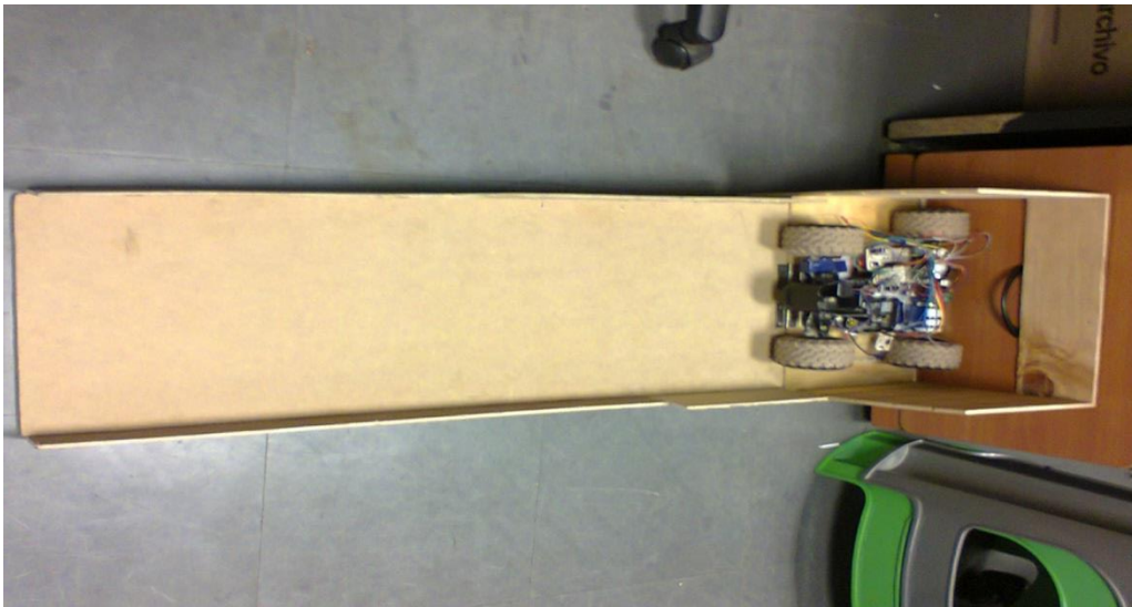
Figura 5. 17 Rampa para las diferentes pruebas que puedan realizar.
