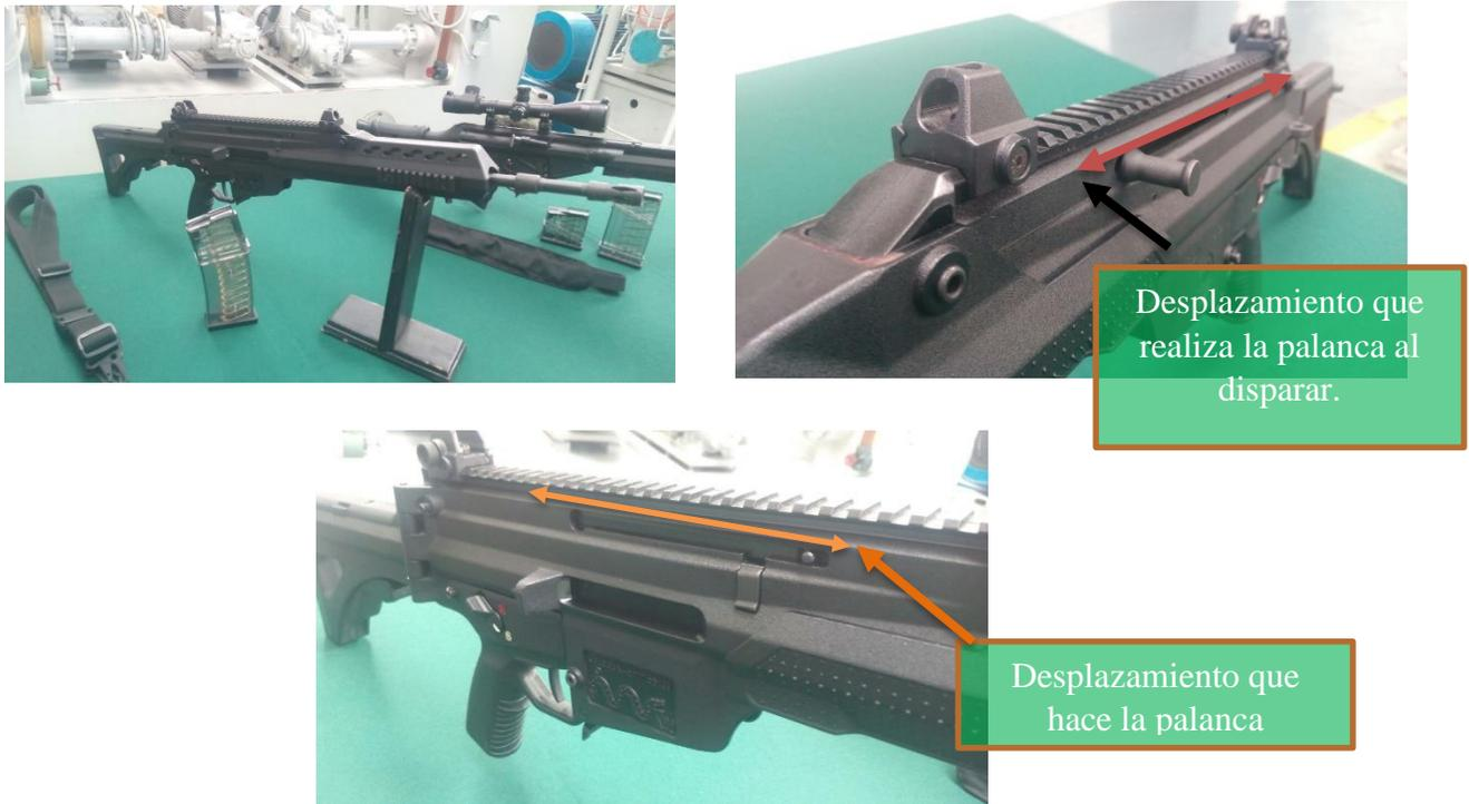
**Figura IV.10.-** Desplazamiento que hace la palanca
