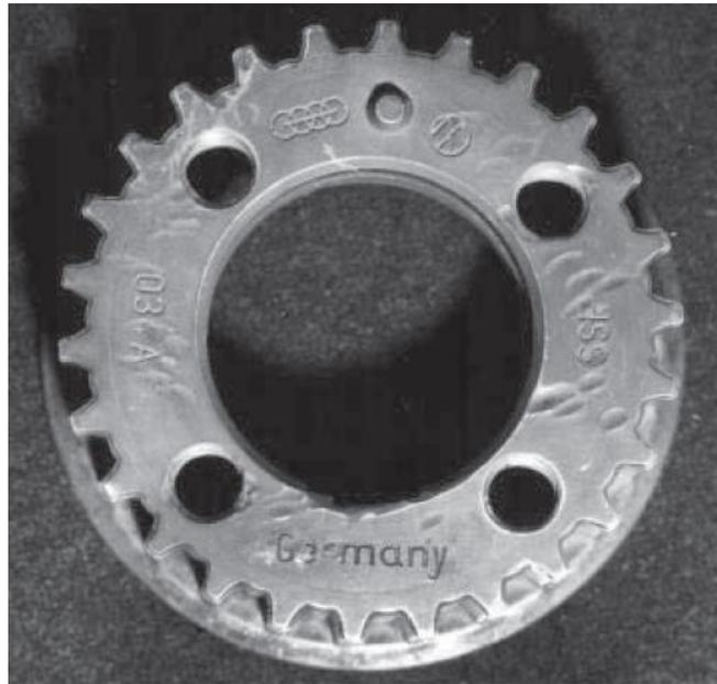
**Figura II.12.-** Engranaje hecho por sinterización
