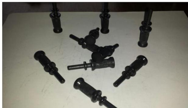
**Figura V.13.- Pieza terminada con recubrimiento de fosfatado**
