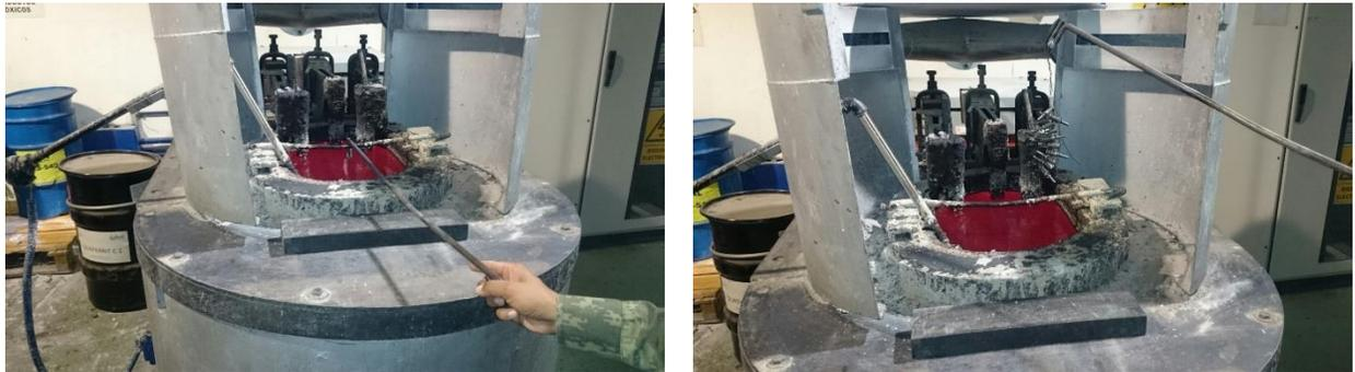
**Figura V.11.-Fosfatado de la pieza**
