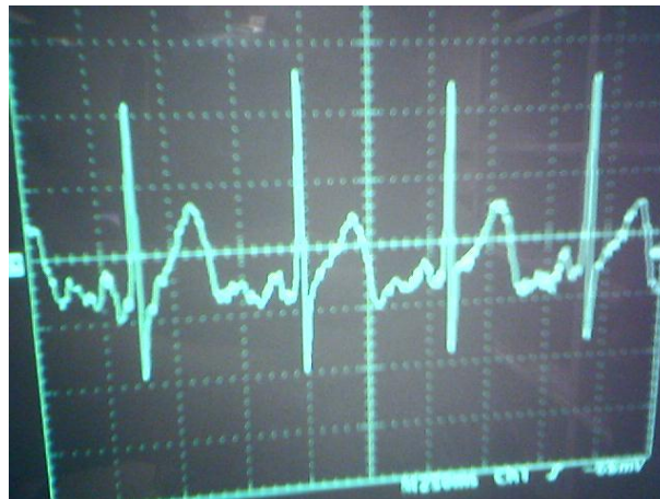
Figura 10.3 Grafica del complejo PQRST desde un osciloscopio
