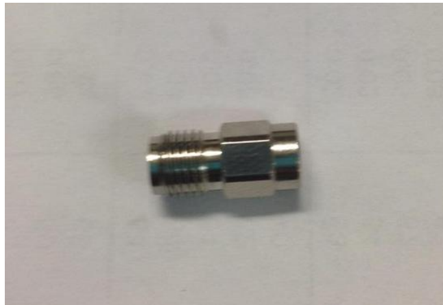
Figura 4.13 Aspecto de la Carga de 50 Ohm utilizada en la Calibración
