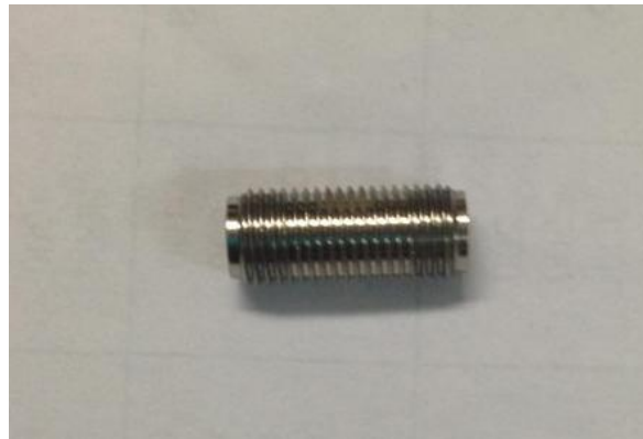
Figura 4.14 Aspecto del Through utilizado en la Calibración
