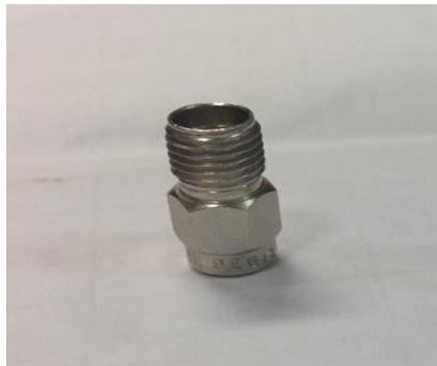
Figura 4.11 Aspecto del Corto utilizado en la calibración
