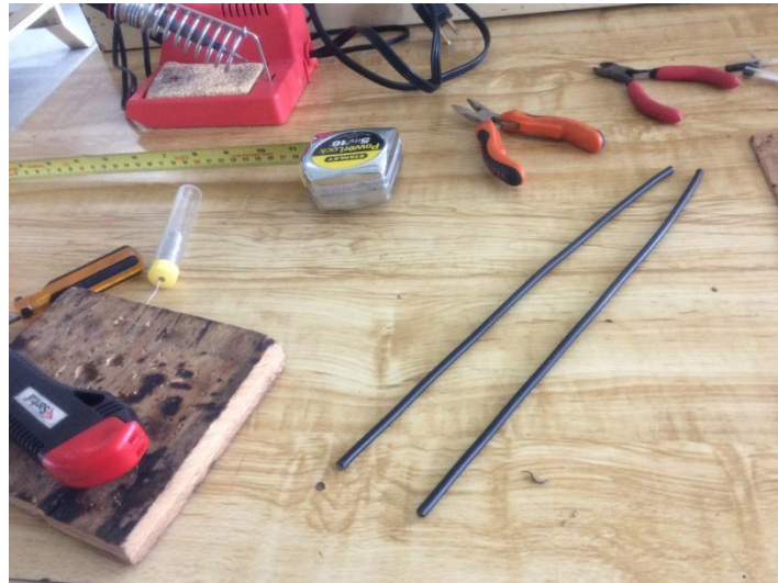
Figura 3.10 Obtención del cable coaxial con el largo requerido
