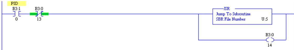
Figura 3.67 Condiciones para ejecutar subrutina
