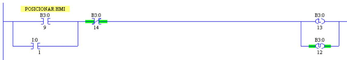
Figura 3.64 Activación de la subrutina de posicionamiento del actuador
