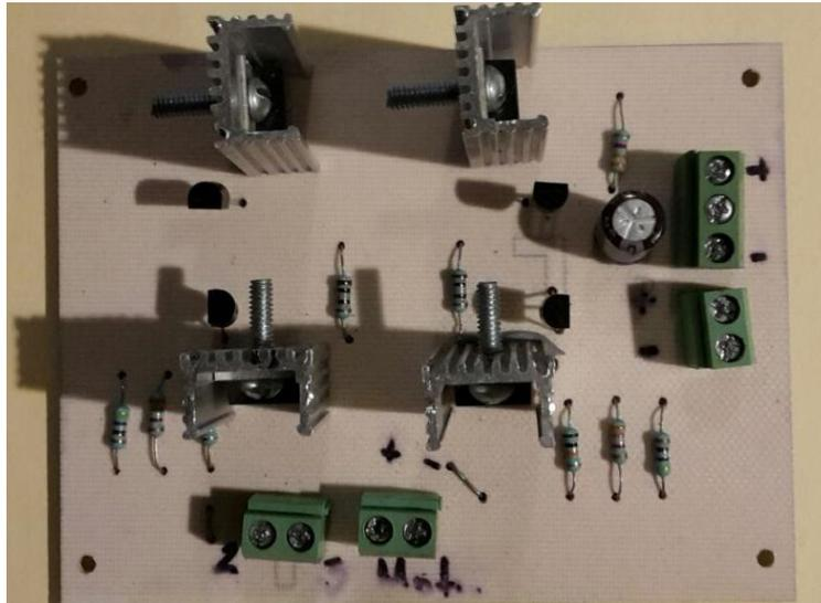
*Figura 4.8 Aplicación del circuito puente H*
