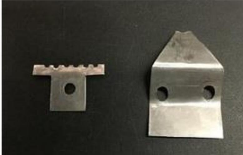
*Fig. 3.2.3 Electrodo de tierra y alta tensión respectivamente*
