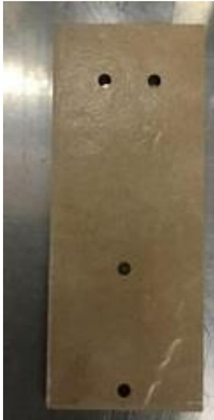
*Fig. 3.2.4 Perforación de la loseta*
