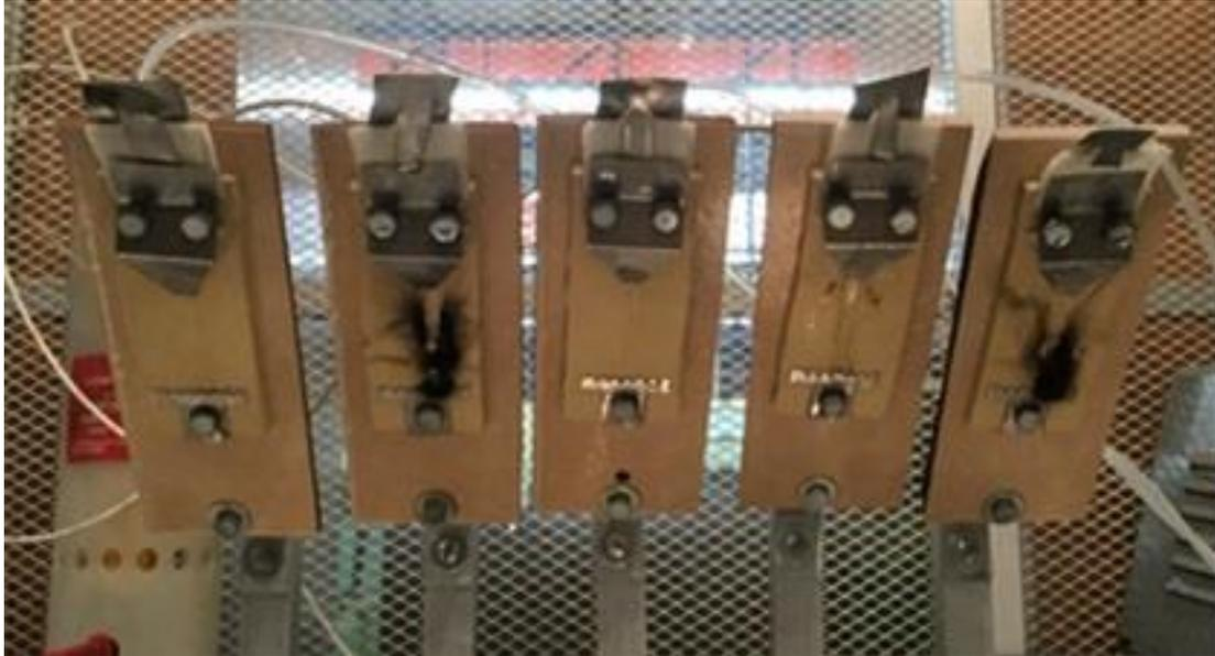
*Fig. 4.1.10 Carbonización en dos de las muestras antes de una hora de prueba.*
