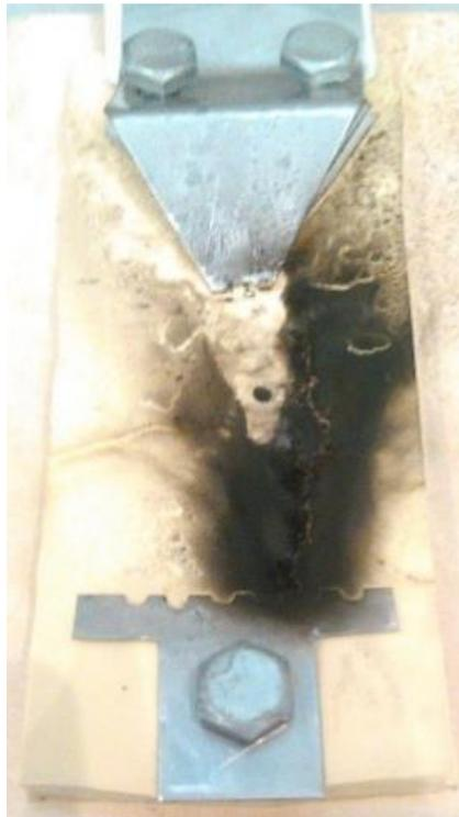
*Fig. 4.1.1 Trayectoria carbonizada de una de las muestras*
