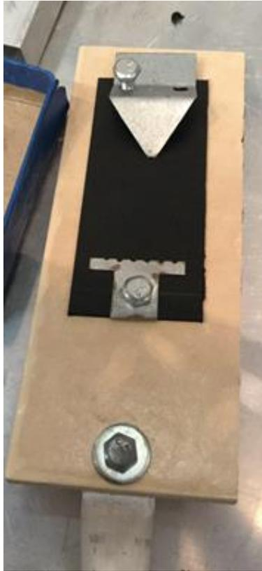
*Fig. 3.2.8 Barra, electrodos y loseta*
