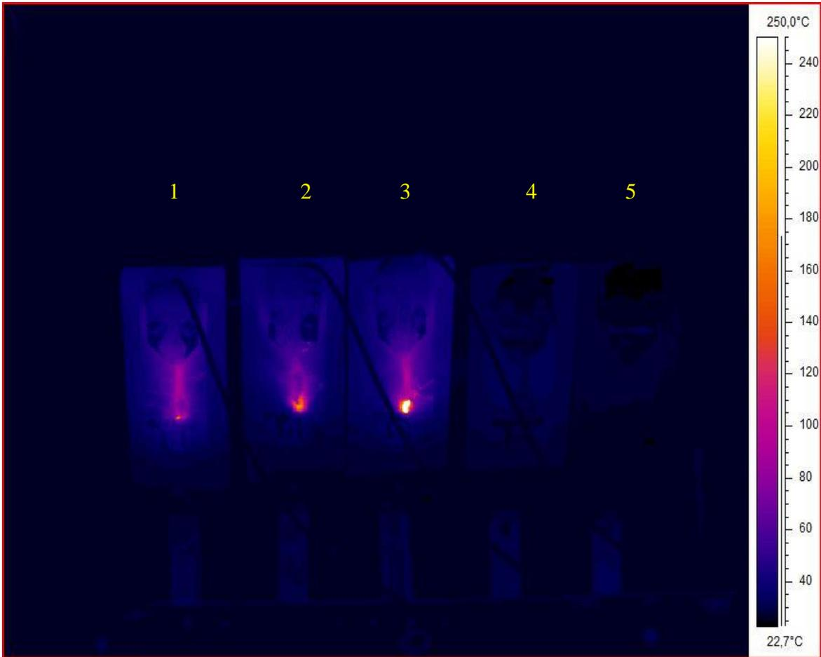
*Fig. 4.1.3 Imagen termográfica del hule con una temperatura máxima de 250°C*
