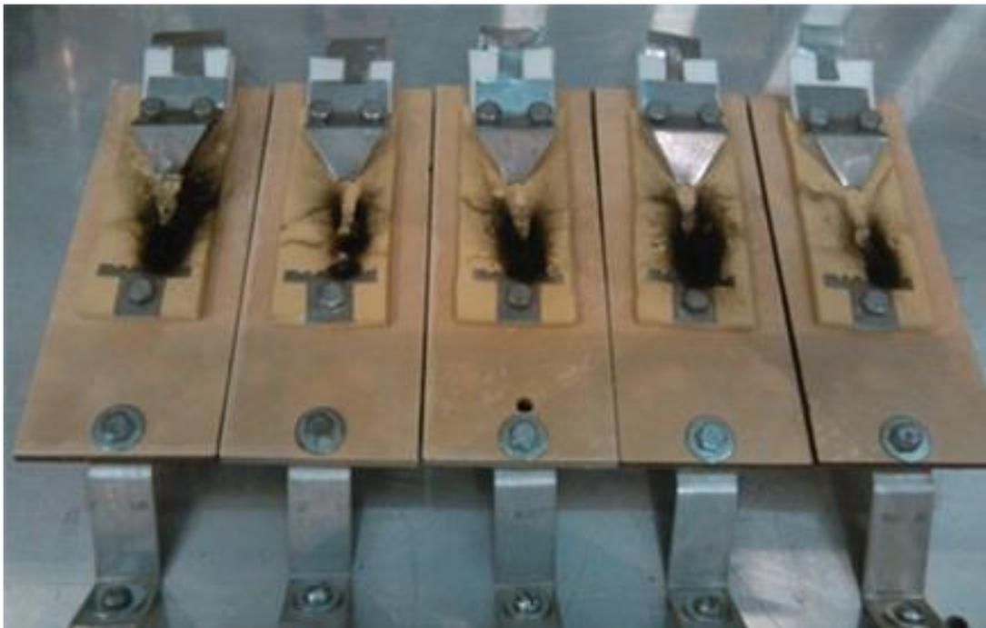
*Fig. 4.1.11 Carbonización en las muestras al final de la prueba.*
