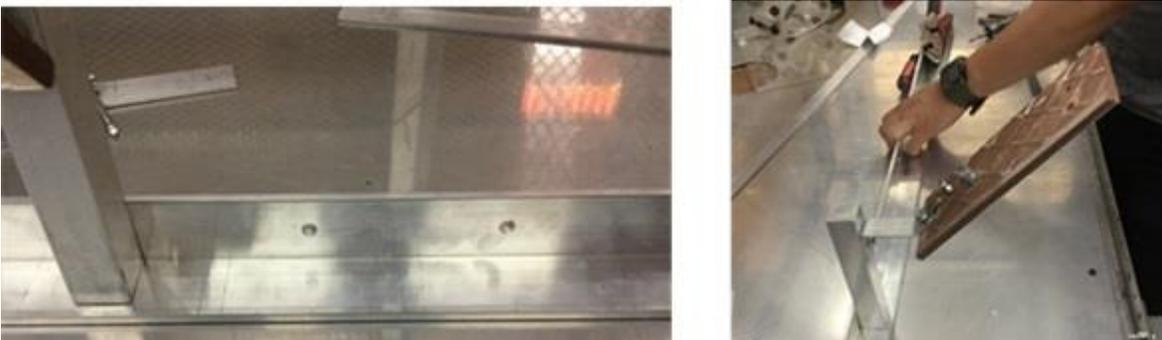
*Fig. 3.2.6 Barra de empotramiento de las muestras*
