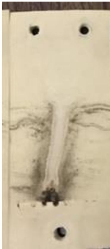
*Fig. 2.2.1 Muestra del daño por descarga eléctrica en un aislante*
