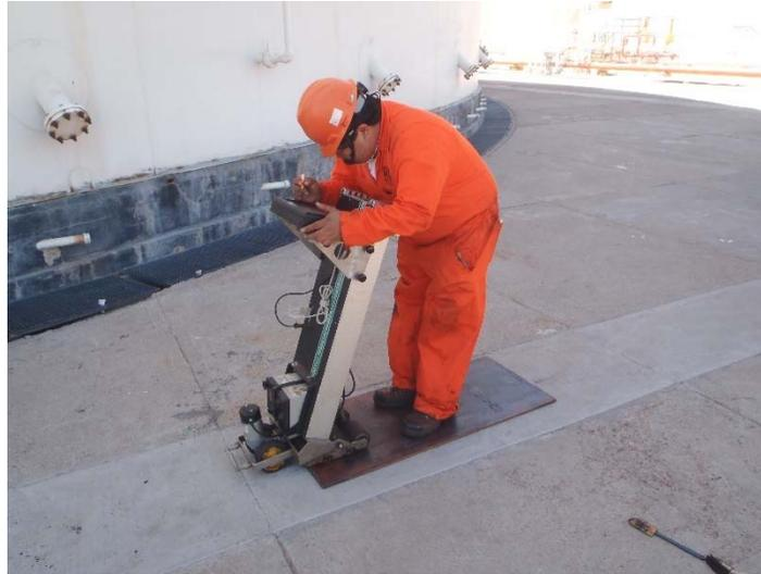
Fig. 36: Calibración de Floormap VS2 con placa de 6mm.
