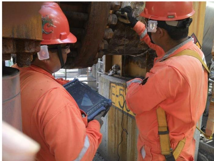
Fig. 21: Inspección de Intercambiador de Calor mediante Arreglo de Fases.
