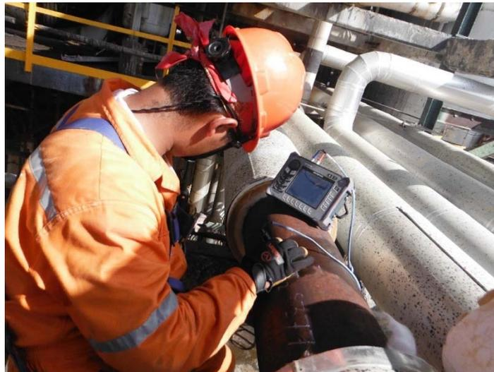
Fig. 19: Inspección de tubería mediante Ultrasonido Industrial Haz Recto.
