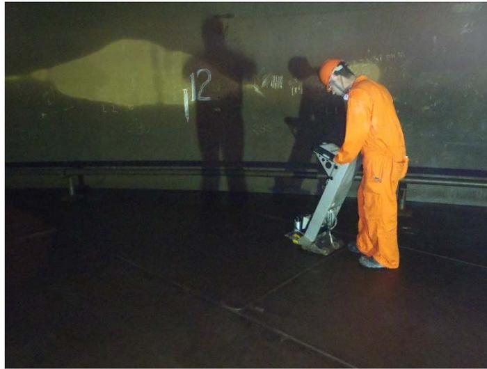
Fig. 24: Inspección de placas de fondo de tanque mediante MFL.
