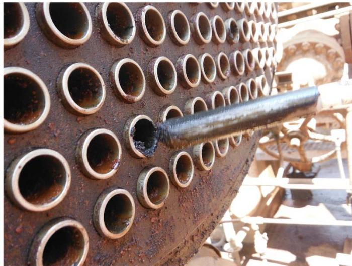
Fig. 22: Inspección de tubos Intercambiador de Calor mediante Corrientes de Eddy.
