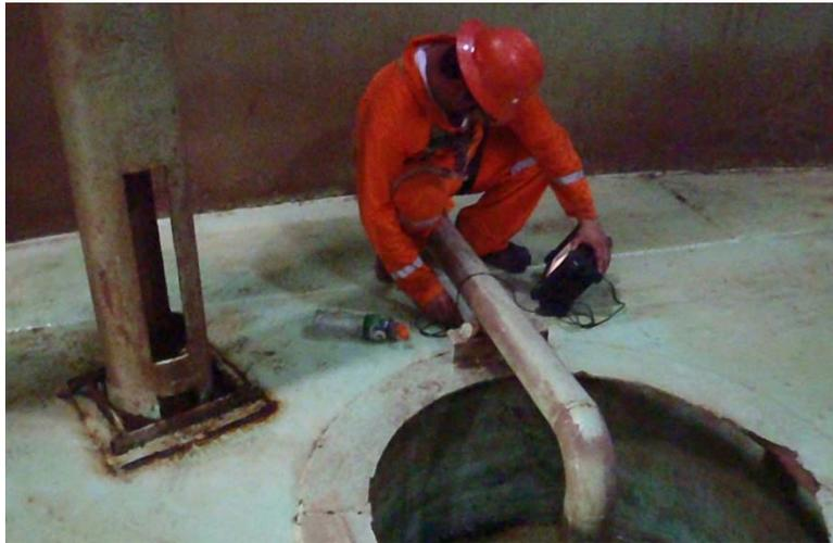
Fig. 44: Escaneo de las placas de fondo con PA.
