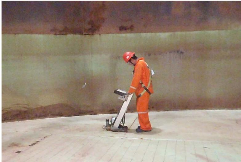
Fig. 42: Escaneo de las placas de fondo mediante Floormap VS2.
