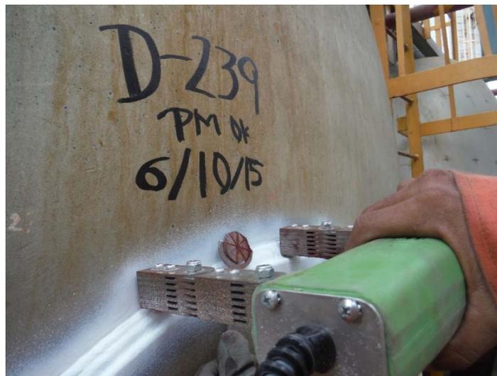
Fig. 18: Inspección mediante Partículas Magnéticas.
