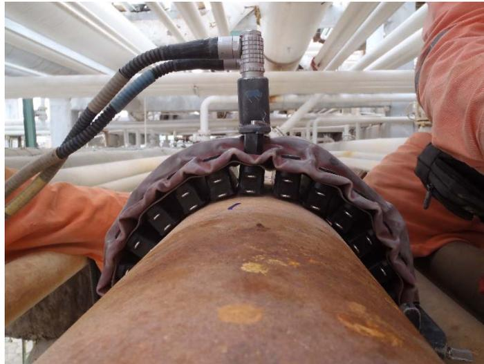
Fig. 20: Inspección de tubería mediante Onda Ultrasónica Guiada.
