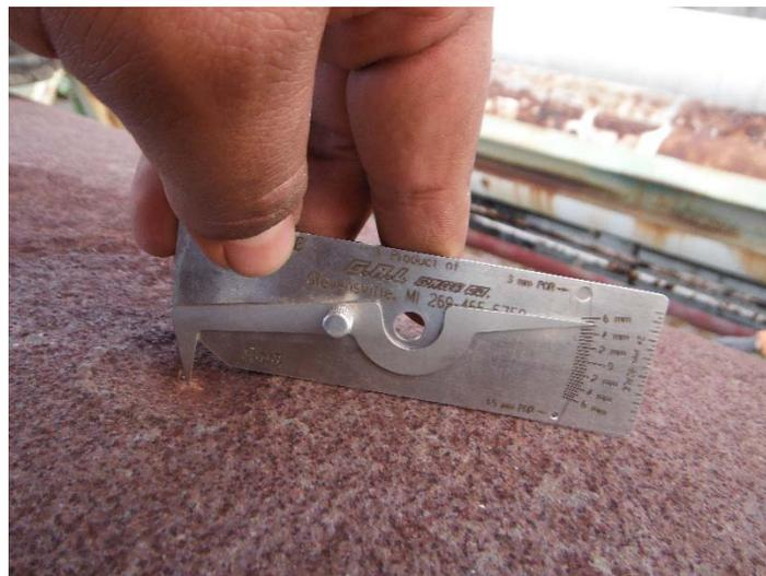
Fig. 15: Medición de profundidad de socavado con medidor de picaduras.
