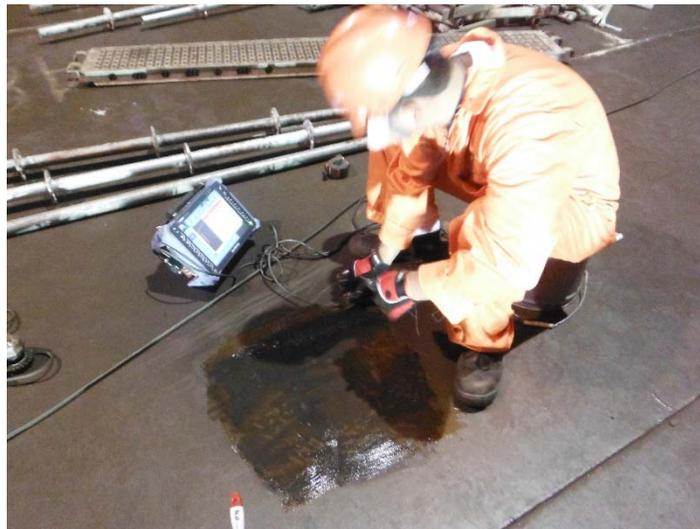
Fig. 39 Verificación por medio de PA.
