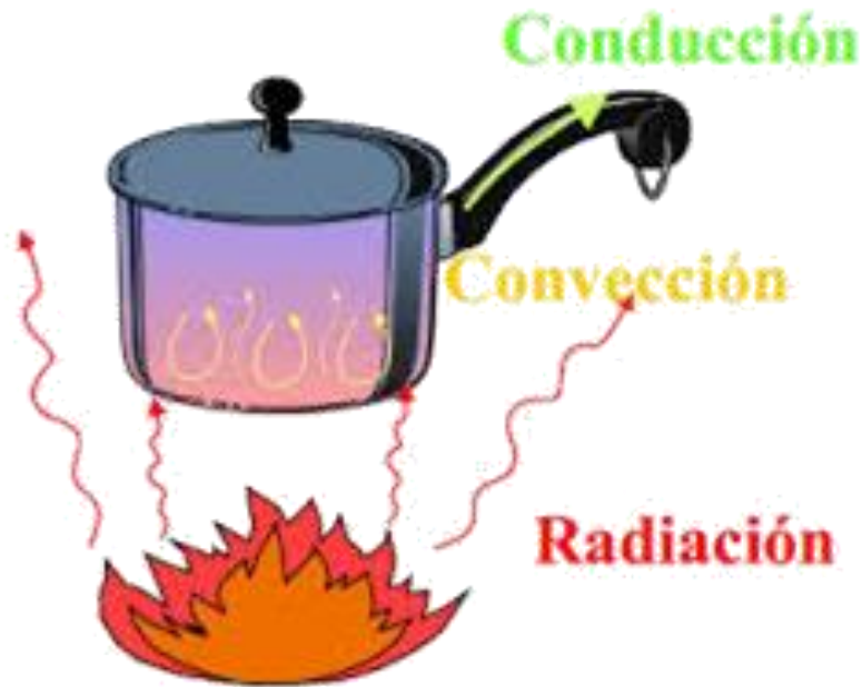
Figura 43. Mecanismos de transferencia de calor.
