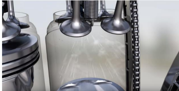
Figura 17. Inyección directa de gasolina EcoBoost [14].
