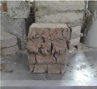
Murete 2 después de la prueba, la ruptura no fue abrupta.
