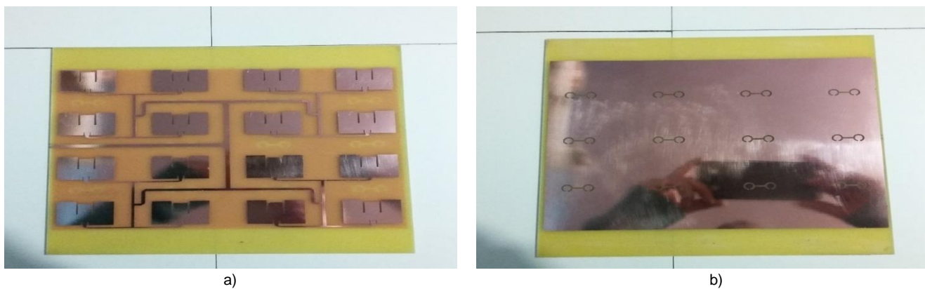
Figura 4.4 Resultado después de introducir el circuito impreso en cloruro férrico. a) Parte frontal de la antena (16 parches), b) Parte trasera de la antena DGS.
