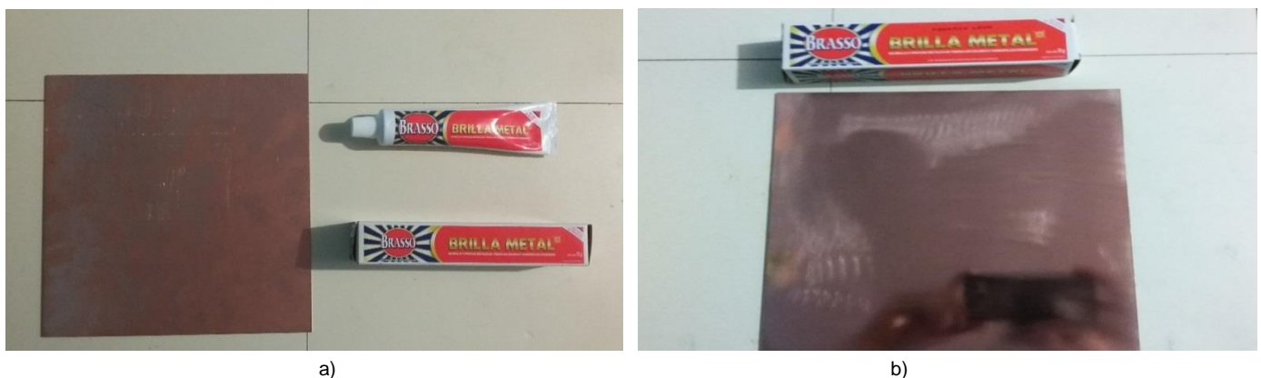
Figura 4.1 Inicio de la construcción. a) Sustrato FR-4 y pulidor. b) Sustrato FR-4 pulido y limpio.
