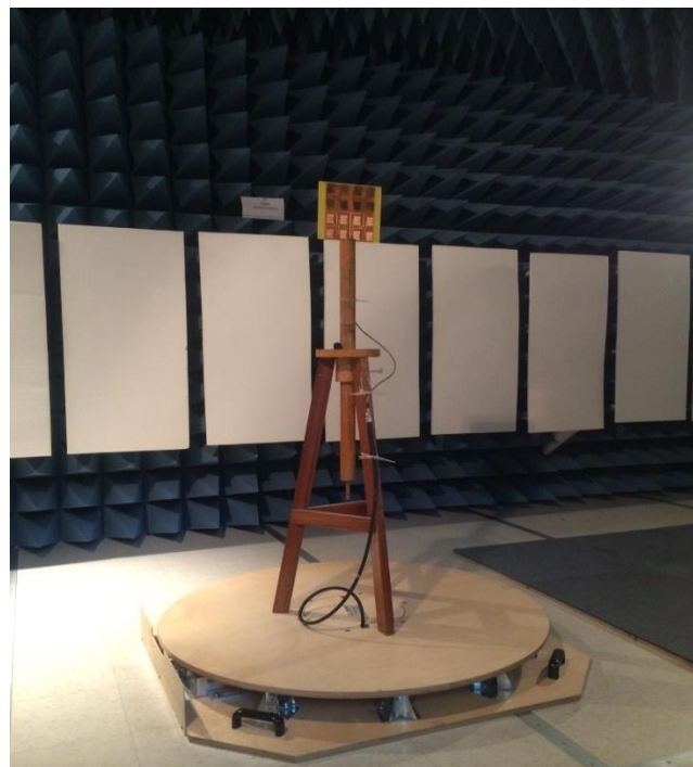
Figura 4.14 Antena receptora montada en la plataforma giratoria.
