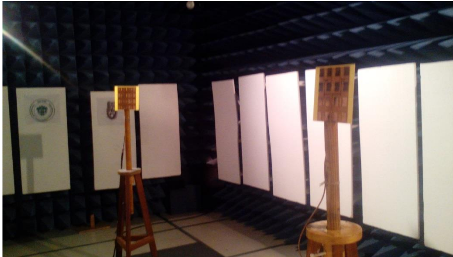
Figura 4.13 Montaje de cada antena en la cámara semi-anecoica.
