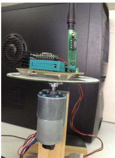
Figura 3.2.1. Fotografía del motor montado para realizar la caracterización.
