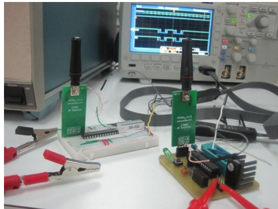
Figura 3.1.1.3. Fotografía tomada en el laboratorio de la prueba realizada para verificar el funcionamiento de los módulos receptor y transmisor
