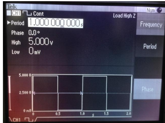
Figura 3.3.2.1. Fotografía de la pantalla del generador de funciones que proporciona una señal cuadrada de 5V y frecuencia de 1Hz.
