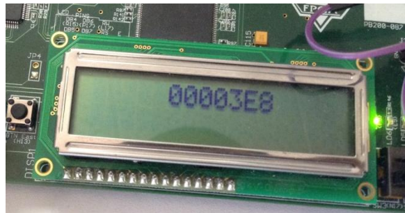
Figura 3.3.2.2. Se muestra en el LCD el valor de la señal periodo en hexadecimal para una señal de entrada “IR” de 1Hz.
