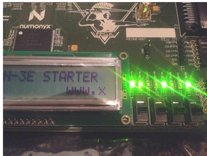
Figura 3.3.1.2: Se observa en los LEDs los 8 bits menos significativos del arreglo que contiene la conversión digital de 1 volt.
