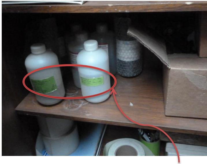
Imagen 12. Recipientes varios no identificados adecuadamente en el área donde se preparan las soluciones para las tinas de galvanizado
