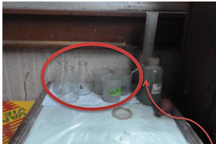
Imagen 11. Instrumentos de laboratorio maltratados y deteriorados en el área donde se preparan las soluciones para las tinas de galvanizado
