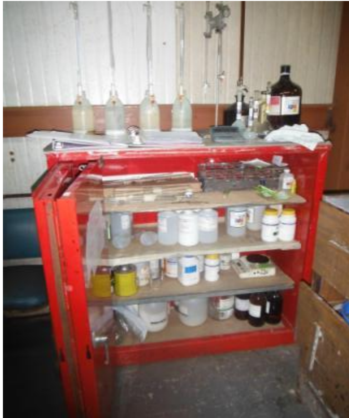
Imagen 5. Almacenamiento en exceso se productos químicos en el laboratorio, algunos son incompatibles entre sí. Riesgo de que se mezclen y generen reacciones peligrosas.
