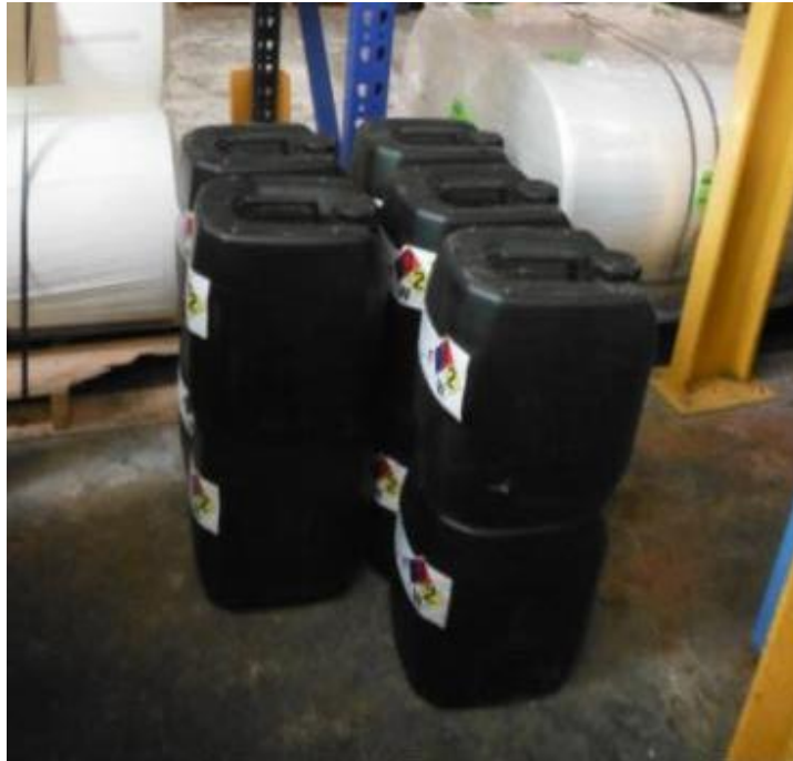
Imagen 7. Porrone con ácido sulfúrico cerca del área de trabajo, riesgo de derrame, la estiba es permitida solo a una hilera.
