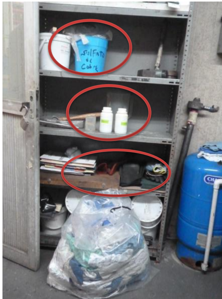
Imagen 9. Área donde se preparan las soluciones para las tinas de galvanizado: Anaquel con varios objetos en desorden, mala identificación de recipientes, uso de contenedores no adecuados, riesgo de derrames en el área, de contaminación de las herramientas de trabajo y de contacto con el trabajador.
