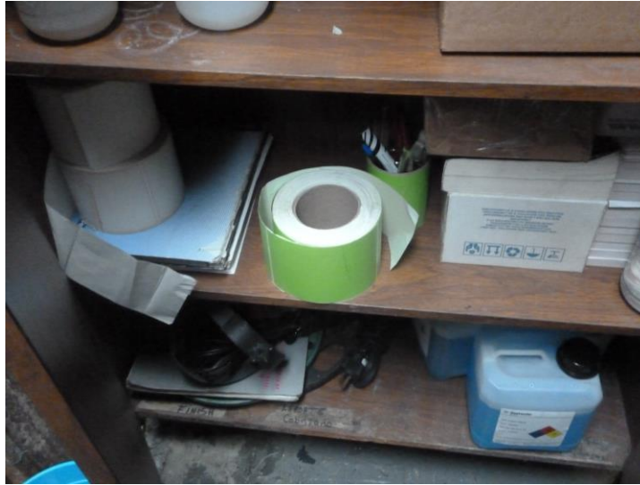
Imagen 3. Artículos personales mezclados con sustancias químicas, implica riesgo de contaminación a los artículos personales y de contacto con el trabajador.
