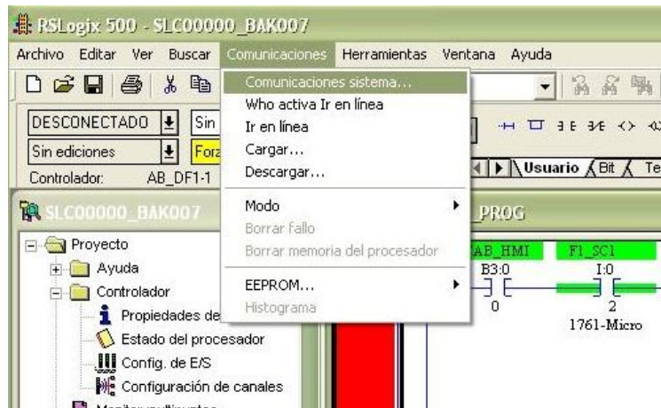
Figura 4.22. Descarga del programa al PLC.
