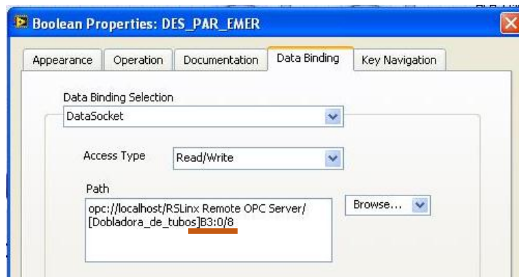
Figura 4.51. Dirección de bits y entradas.
