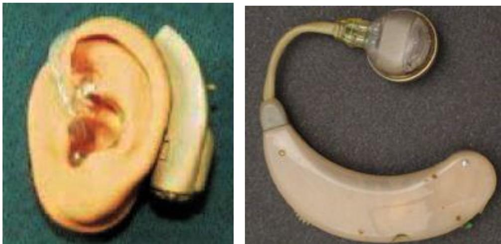
**Figura I.16.-** *Oticon 550T* modelo con control de volumen, encendido y apagado
