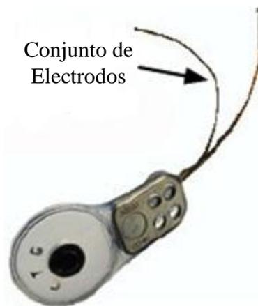
**Figura I.19.-** Electrodo de un implante coclear (I.C.)
