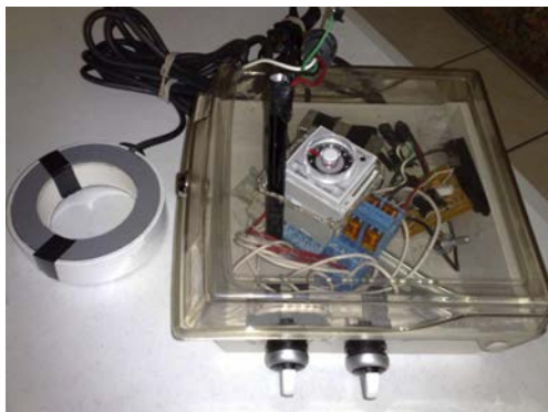
Figura 57. Primer Prototipo láser más campo magnético
