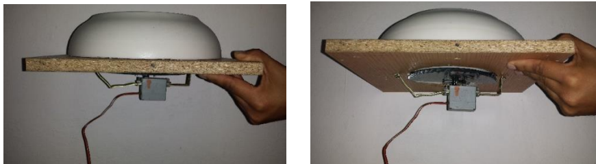
Figura 38. Servomotor incorporado a la base del contenedor.
