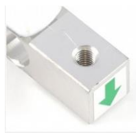
Figura 11. Celda de carga flecha de indicación
