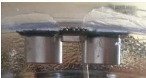
Figura 48. Sensor ultrasónico colocado en contenedor
