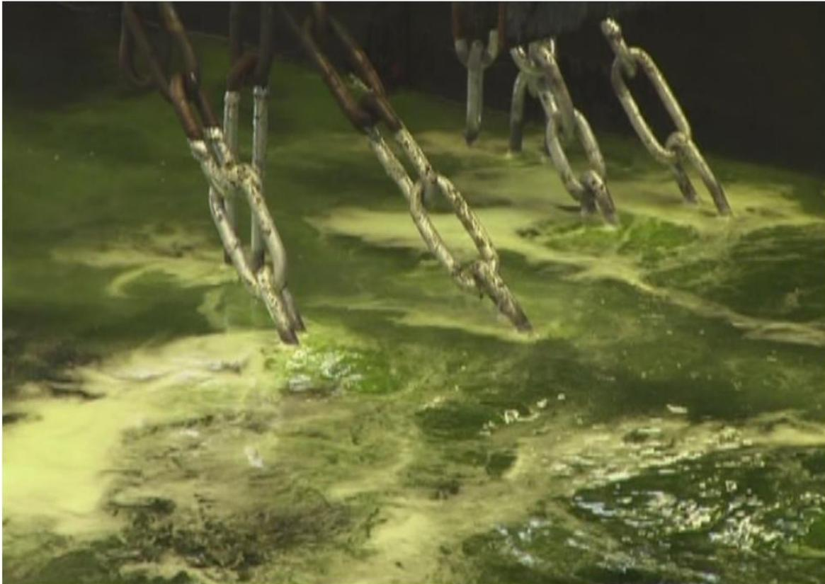
**Figura 2.5: Decapado de una pieza metálica en solución de ácido clorhídrico (Asociación Latinoamericana de Zinc - LATIZA)**
