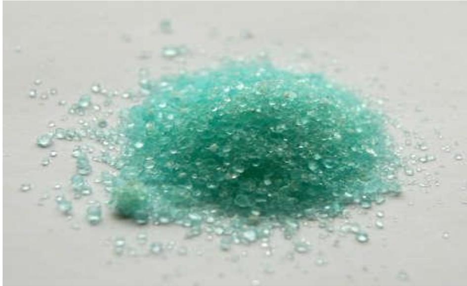
**Figura 5.1: Sal heptahidratada de sulfato de hierro II**
