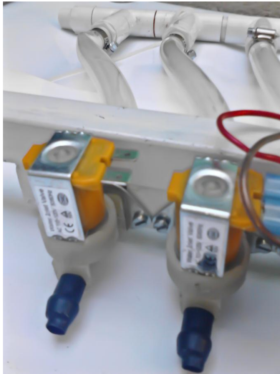
Figura 30. Separación mínima entre electroválvulas.
