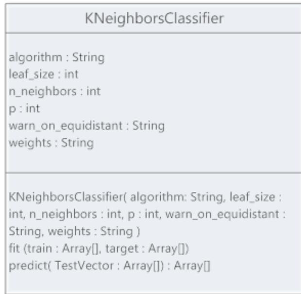
**Imagen 8.1.1:** Diagrama de clases del Prototipo III KNN.
