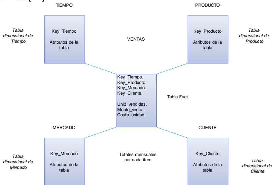
Figura 40. “Ejemplo de un esquema estrella para una base de datos con dimensiones de tiempo, producto, mercado y cliente”.
