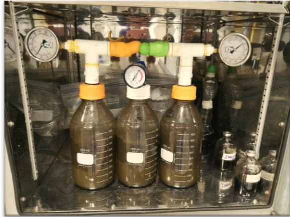
Figura 17. Recipientes de litro ensamblados dentro de incubadora a 55°C.
