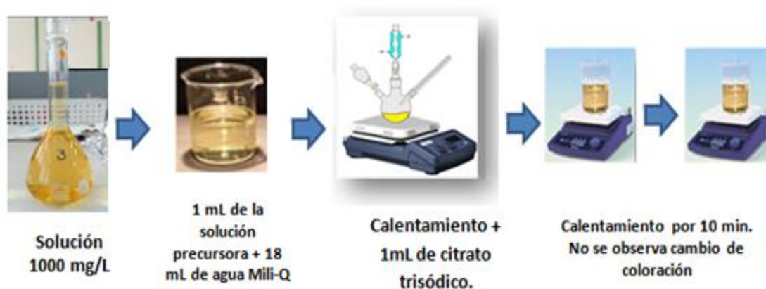
Figura 3.7 Síntesis de AuNPs a partir de desechos electrónicos.
