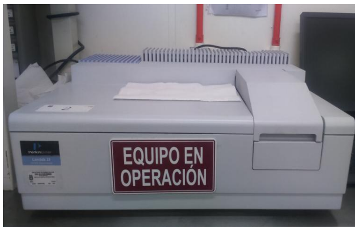
Figura 3.8 Espectrofotómetro UV-Vis Lambda 25, Perkin Elmer.
