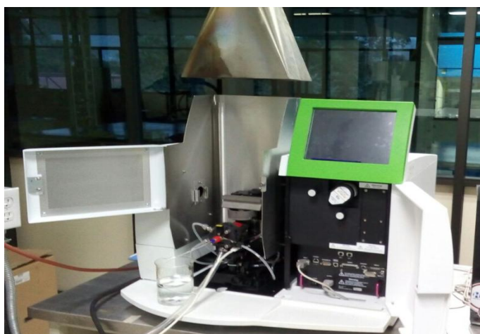
Figura 3.13 Espectrofotómetro de Absorción Perkin Elmer, modelo AAnalyst200.
