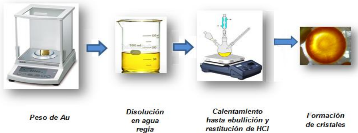
Figura 3.1 Esquema de síntesis de \text{H[AuCl}_4\text{]} a partir de oro comercial.
