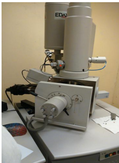
Figura 3.11 Microscopio Electrónico de Barrido FEI, modelo SIRION.
