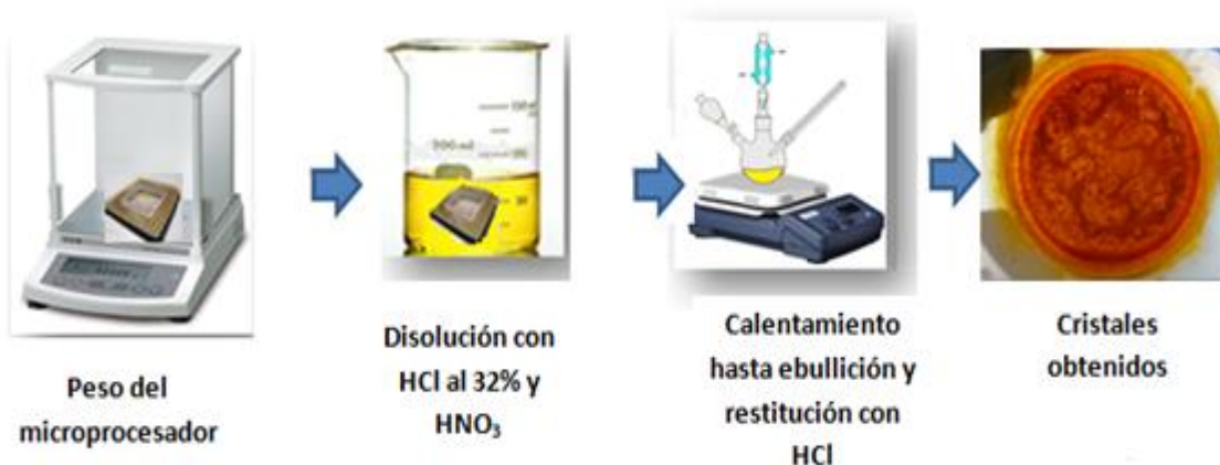
Figura 3.6 Síntesis del reactivo precursor de AuNPs a partir de desechos electrónicos.
