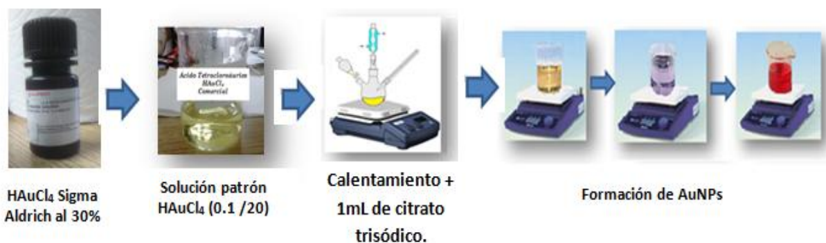
Figura 3.3 Síntesis de AuNPs a partir de HAuCl 4 comercial.
