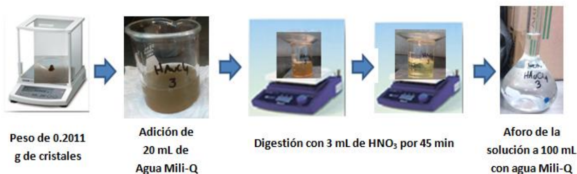
Figura 3.12 Preparación de la muestra de cristales obtenidos de desechos electrónicos para la cuantificación de Cu y Au por AAS.
