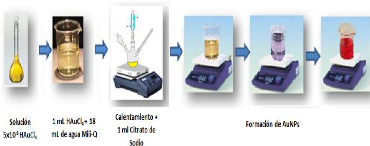
Figura 3.2 Esquema de síntesis de AuNPs a partir de oro comercial.
