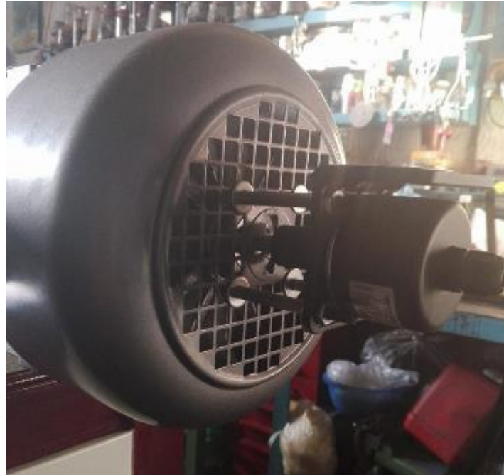
Figura 4.6 Ensamble de encoder con motorreductor
