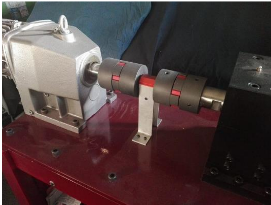
Figura 4.2 Ensamble del sensor de torque en línea con motorreductor y chumaceras
