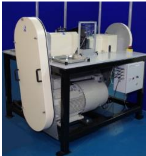
Figura 2.9 Modelo de discos encontrados TE74 producido por Phoenix Tribology.
