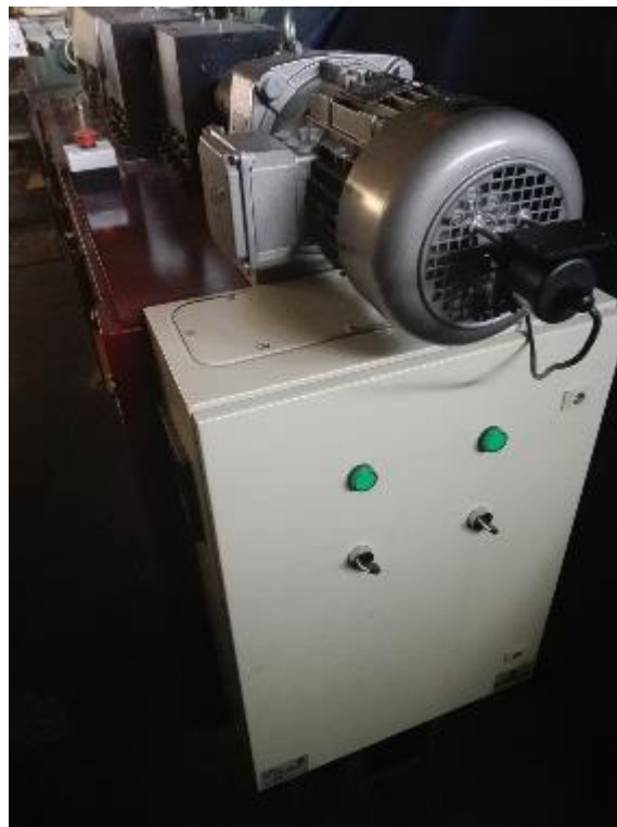
Figura 4.7 Fijación del gabinete de control con la estructura
