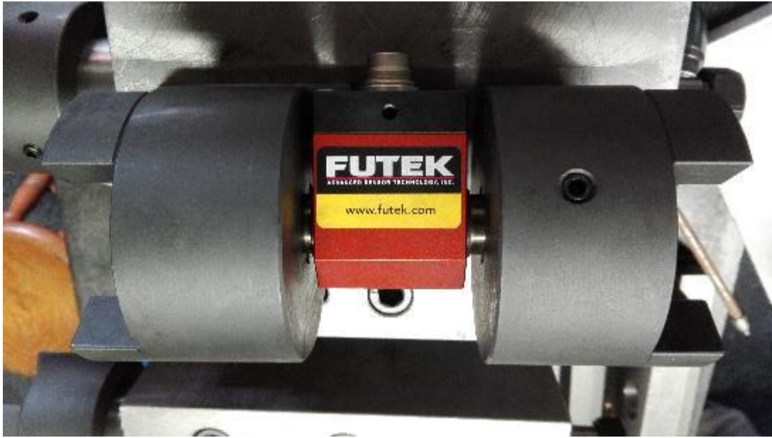
Figura 4.3 Ensamble del sensor de torque entre coples
