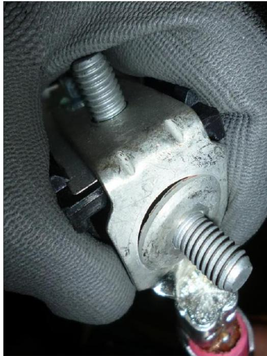
*Figura 3.19* Conector con fractura [5]
