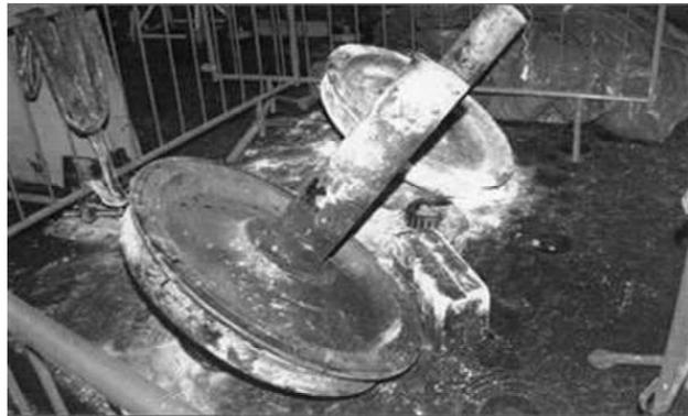
*Figura 1.1 Eje fracturado de tren [11]*
