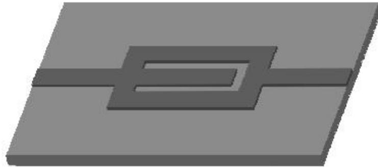
*Figura 3.3 Filtro EBG. Imagen extraída de [10]*
