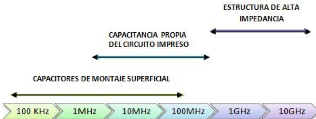
*Figura 1.6 Técnicas utilizadas para reducir el Ruido de Conmutación Simultánea dependiendo del intervalo de frecuencia. Imagen extraída de [3].*
