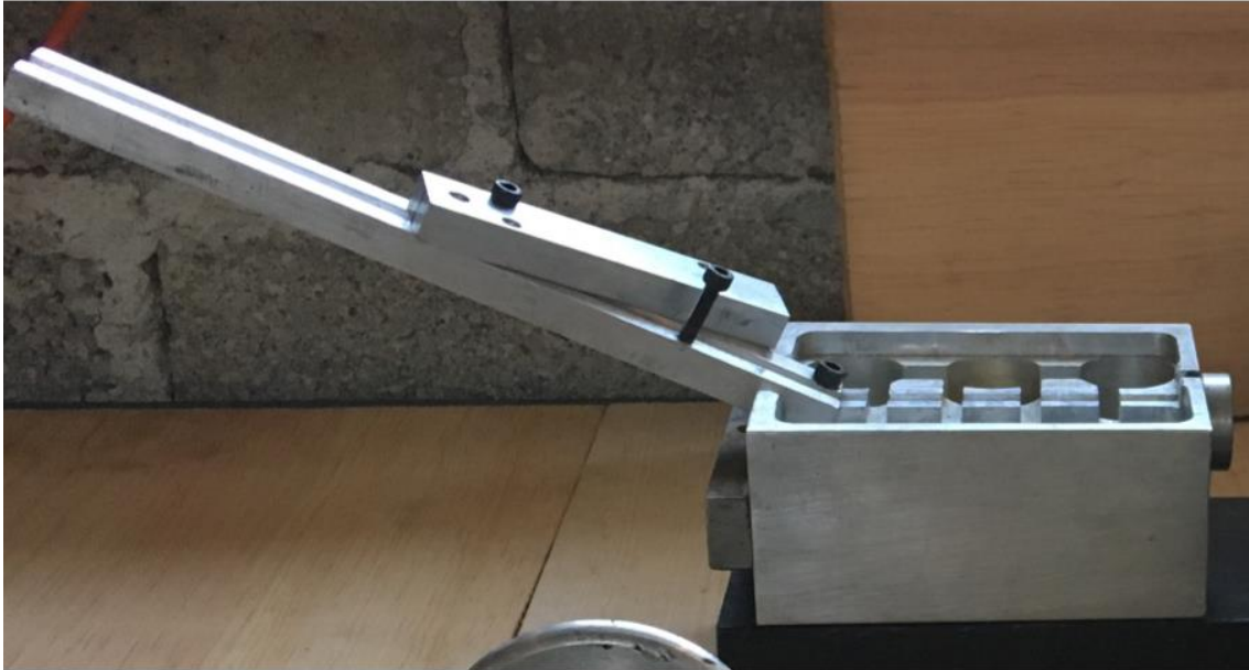
Figura 4. 29 Inclinación del canal de enfriamiento
