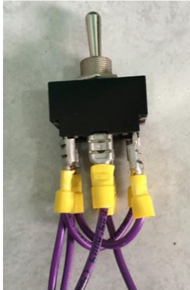
Figura 4. 24 Conexión cambio de giro del motor
