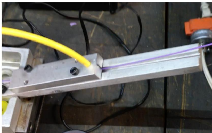
Figura 4. 28 Canal de enfriamiento
