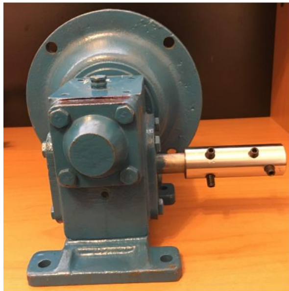
Figura 4. 17 Reductor de velocidad (29:1)
