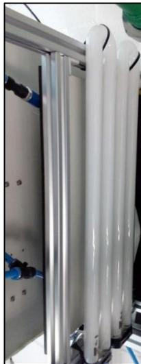
Figura 2.13. Estructura de sujeción de lámparas.
