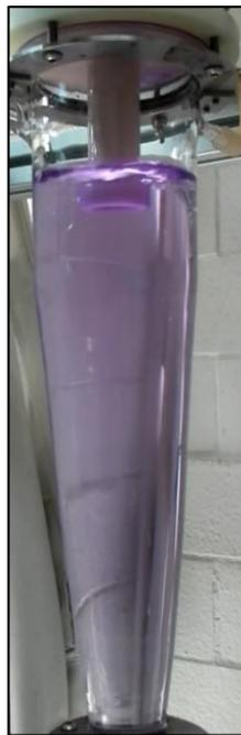
Figura 4.16. RH con  $F_1 = 4.1$  l / min sin la alimentación de aire.
