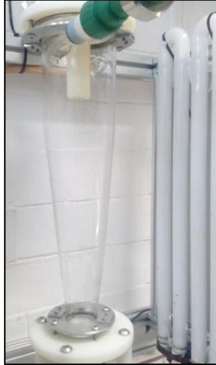
Figura 2.12. Posición del sistema de iluminación a los costados del RH.
