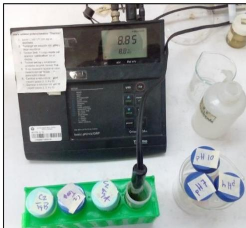
Figura 3.5. Medición del pH de una muestra en un tubo falcon.
