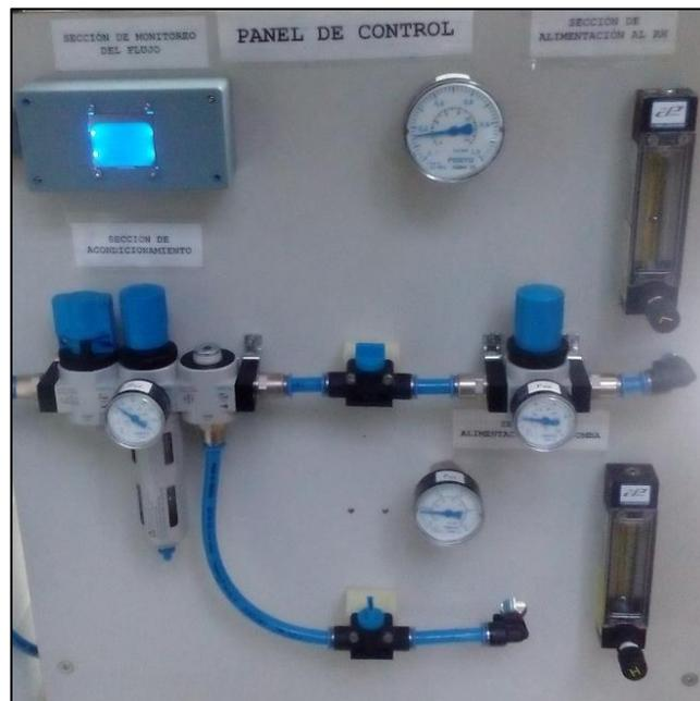
Figura 3.1. Panel de control de los sistemas hidráulico y neumático.
