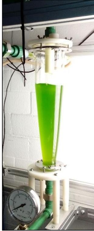
Figura 4.40. RH en funcionamiento para la cinética de crecimiento de *S. incrassatulus*.
