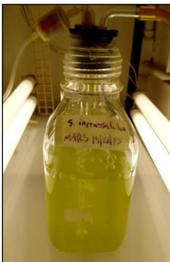
Figura 4.37. Botella de cara plana utilizada como reactor.
