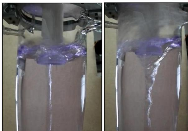
Figura 4.27. Comportamiento del flujo con alimentación de líquido  $F_1 = 6.4$  l / min y caudal mínimo (izquierda) y máximo (derecha) de aire.
