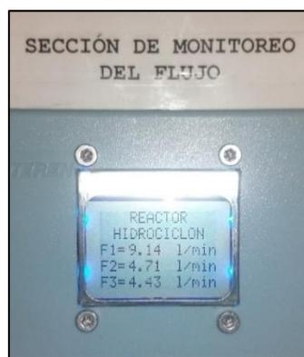
Figura 4.14. Pantalla indicando el valor de los flujos  $F_1$ ,  $F_2$  y  $F_3$ .
