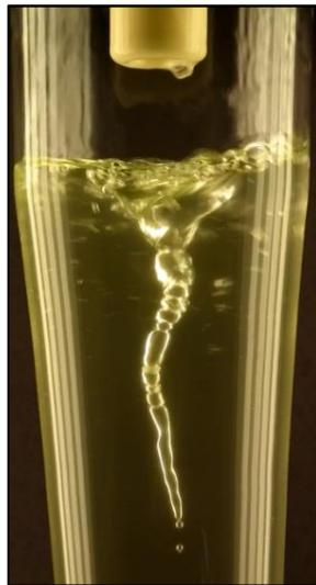
Figura 4.29. Núcleo de aire dentro del RH donde se aprecia que su eje no es lineal ni simétrico.
