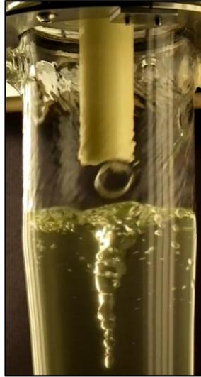
Figura 4.30. Burbujas que se generan por la interacción del flujo de líquido y gas.
