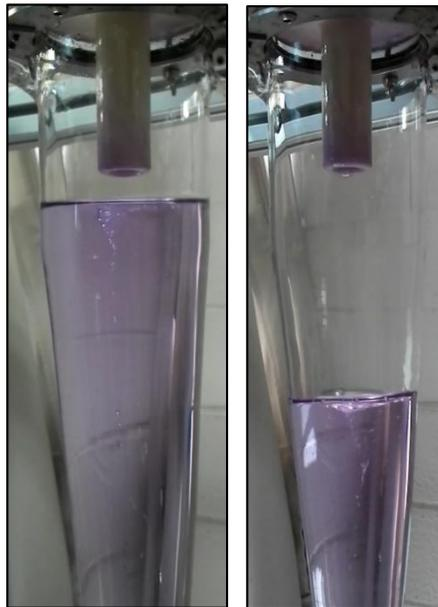
Figura 4.20. Niveles del líquido en el RH con el caudal de aire al 10% (izquierda) y 100% (derecha).
