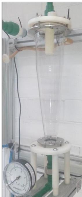
Figura 4.3. Ensamble completo del RH.
