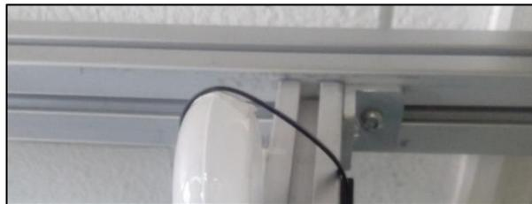
Figura 2.17. Tipo de uniones que facilitan la variación de la posición de las lámparas.
