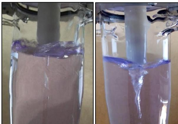
Figura 4.26. Comportamiento del flujo con alimentación de líquido  $F_1 = 4.9$  l / min y caudal mínimo (izquierda) y máximo (derecha) de aire.
