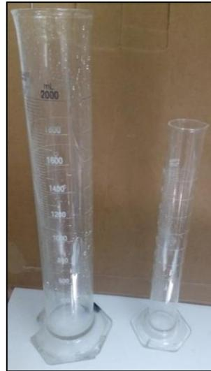
Figura 3.3. Probetas utilizadas en la medición del volumen.
