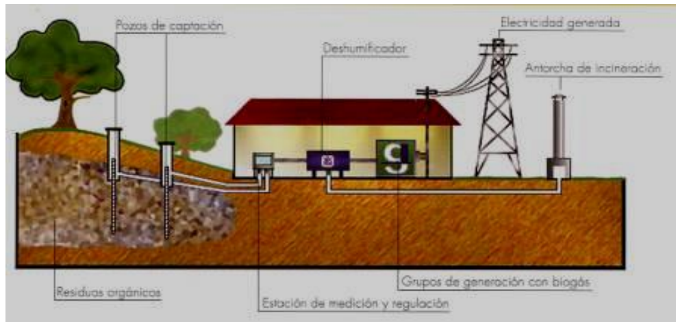
Figura 7. Planta piloto de Biogás.
