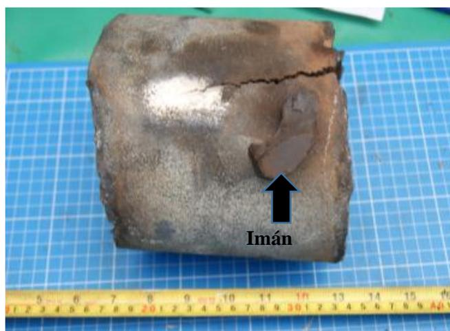
**Figura 46.** Presencia de magnetismo en el fragmento del tubo #73, zona final de la fractura.
