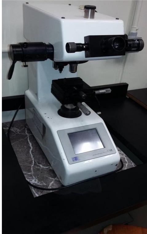
**Figura 18.** Durómetro Future Tech modelo F-810 HV.
