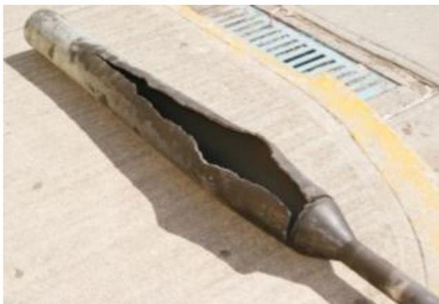
**Figura 10.** Tubo #73 proveniente del reformador de hidrogeno BA-900.
