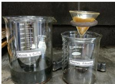
Figura 30. Filtración de resinas
