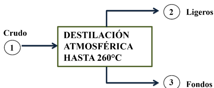
Figura 33. Diagrama de flujo de destilación atmosférica
