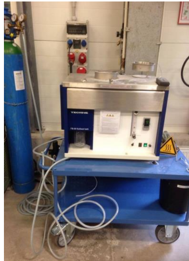
Figura 26. Equipo utilizado en HZG para el tratamiento térmico de recristalización para la aleación ZK60 modificada.
