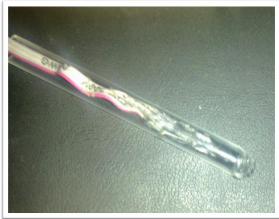
Ilustración 37 Sensor prototipo con recubrimiento de vidrio
