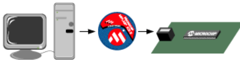
Ilustración 33 Diagrama de conexión de circuito a computadora con ICD
