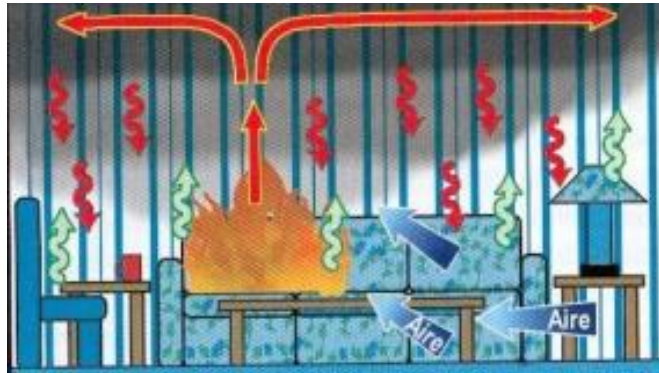
Figura 14 a. Situación previa al flashover
