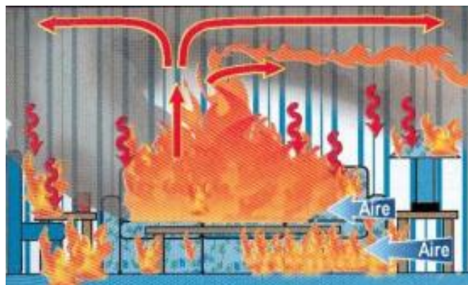
Figura 14 b. Condición de flashover
