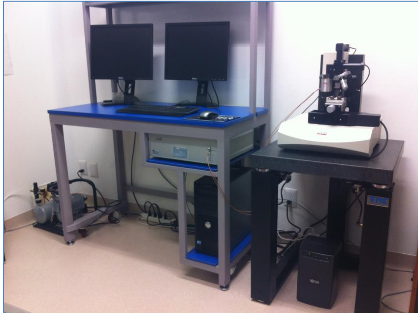
Figura 3.3 Nanoindentador TTX-NHT Instruments. Propiedad del Centro de Nano ciencias y Micro y Nanotecnologías del I.P.N.
