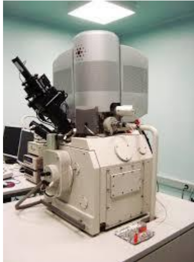
Figura 3.6. Equipo de Microscopía electrónica de barrido QUANTA 3D FEG, Propiedad del Centro de Nanociencias y Micro Nanotecnologías del I.P.N.
