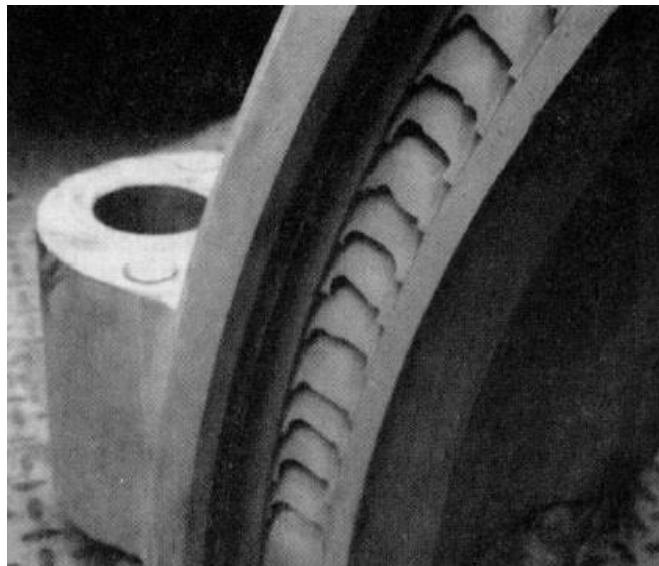
Figura II. Componente dañado por el impacto de partículas sólidas. (Urm et al , 2006)
