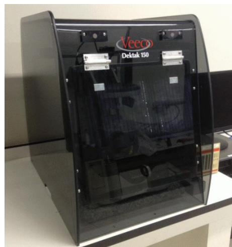
Figura 3.7. Rugosímetro mecánico marca Veeco, modelo DEKTAK 150, equipo que pertenece al Centro de Nanociencias y Micro Nanotecnologías del I.P.N.
