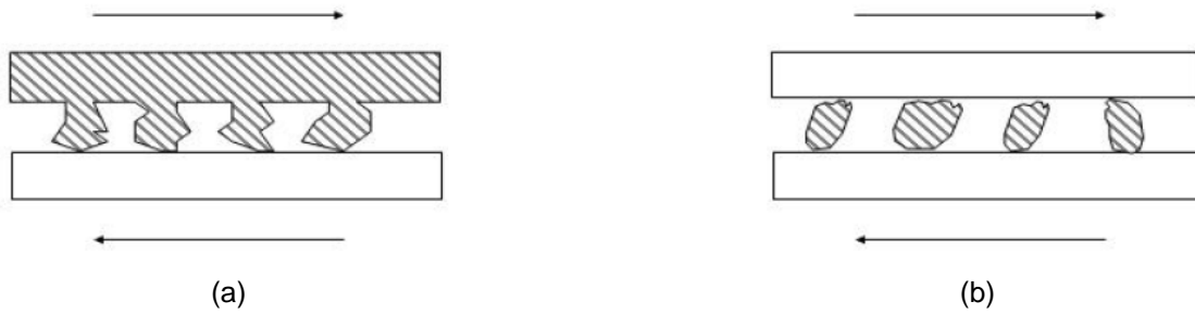
Figura 1.4. Tipos de abrasión: (a) abrasión de dos cuerpos y (b) abrasión de tres cuerpos (Fini et al , 1992).
