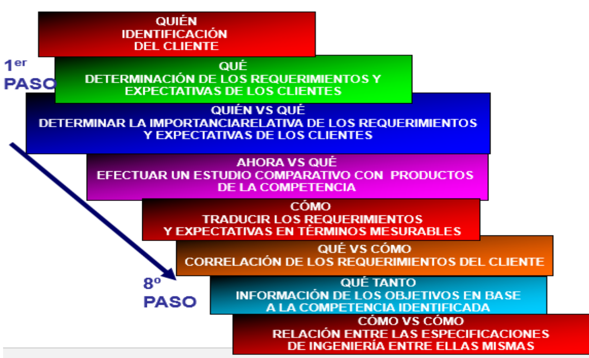
Figura 2.1. Esquema de la técnica de despliegue de funciones de la calidad (QFD).
