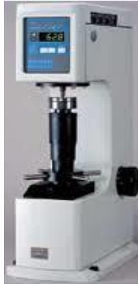
Figura 0.6 Durometro para indentacion Rockwell-C
