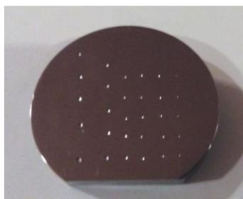
Figura 0.4 #.- indentaciones realizadas a cargas altas sobre la superficie del acero borurado AISI 316L
