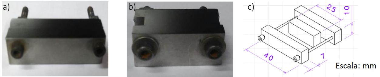
**Figura 0.5** Dispositivo de acero inoxidable AISI 304 a) sin muestra b) con muestra montada
