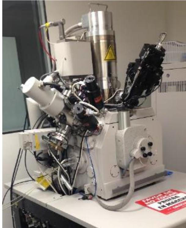
Figura 0.9 Microscopio Electrónico de Barrido Quanta 3D FEG, marca FEI
