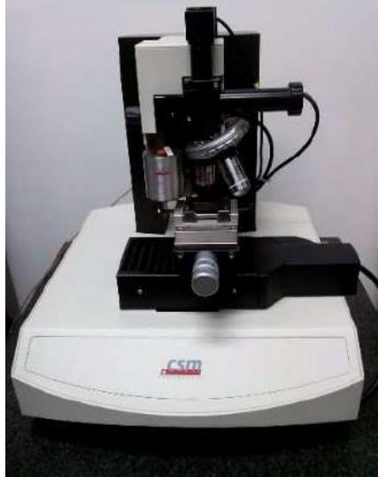
Figura 0.10 Equipo Tester NHT de la marca CSM Instruments para Nanoindentación.
