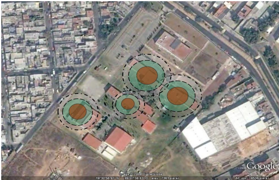
Fotografía No. 15.- Posibles disturbios que se pudieran ocasionar en caso de alguna explosión de los tanques de almacenamiento de gas Lp.
