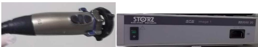
Figura IV- 11. Cámara de 3 chips del Quirófano 6 y su Unidad de Control (CCU)
