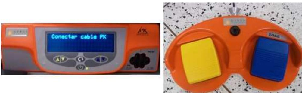
Figura IV- 43. Unidad Bipolar Gyrus con su pedal
