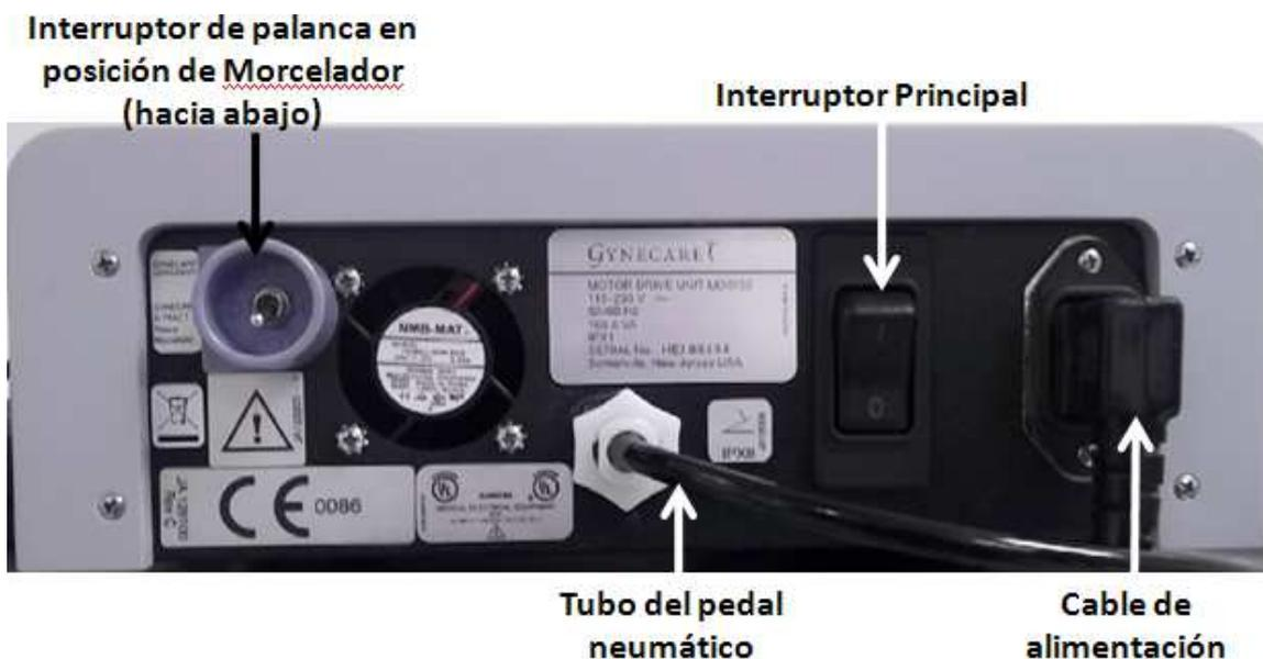
Figura IV- 34. Controles y conexiones del panel posterior del Morcelador
