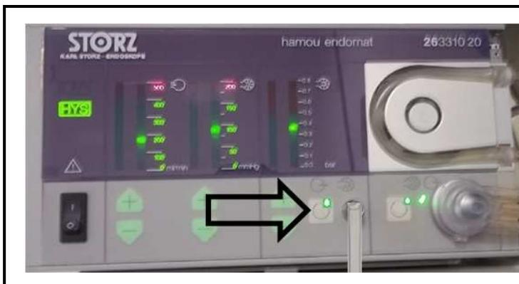
3. Poner en funcionamiento la Bomba de Vacío oprimiendo el botón de *STANDBY*. El foco del botón cambia a VERDE y comienza a Succionar. La succión es muy Leve
