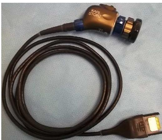
Figura IV- 4. Cabezal de cámara de 3 chips mostrando su cable
