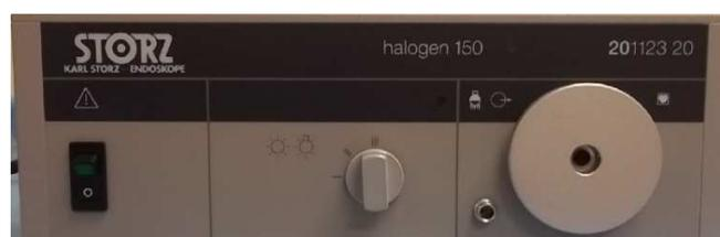
Figura IV- 16. Fuente de Luz de Halógeno con perilla de 3 niveles
