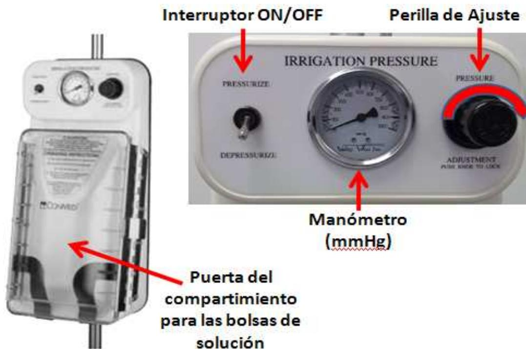
Figura IV- 30. Controles de la bomba de irrigación
