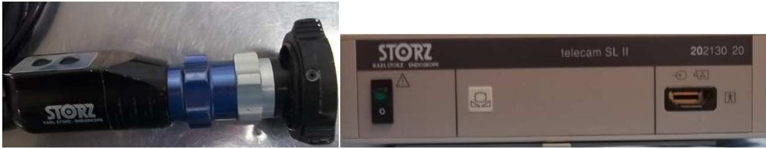
Figura IV- 12. Cámara de 1 chip complementaria y su Unidad de Control (CCU)
