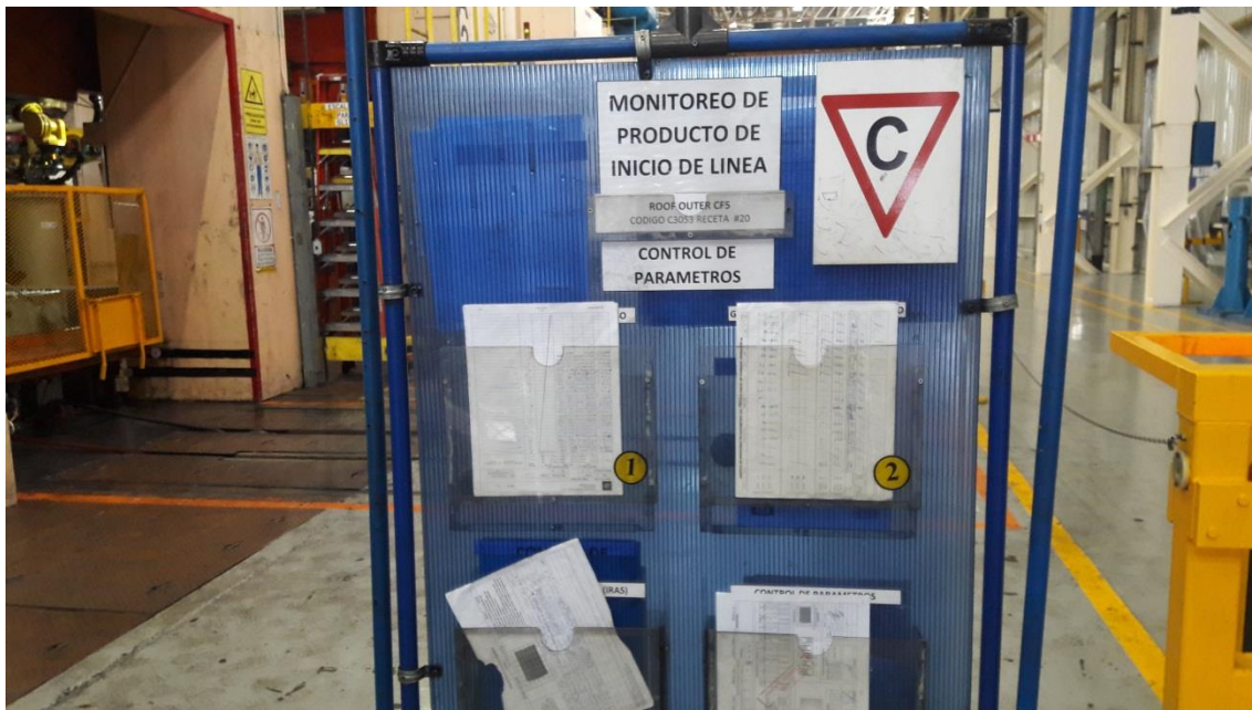
Figura 69. Tablero de seguimiento de parámetros en línea de producción.
