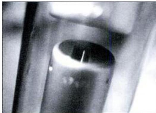
**Ilustración 8. Filamento en el ánodo fijo**
