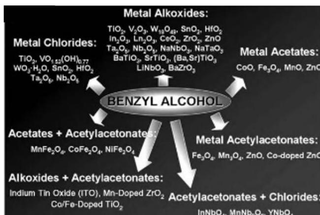
Figura 36. Nanopartículas de óxidos metálicos sintetizadas por la ruta del alcohol bencílico.
