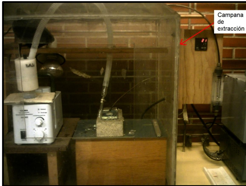
Figura 2. Fotografía del equipo de RPU donde se muestra la campana de extracción.
