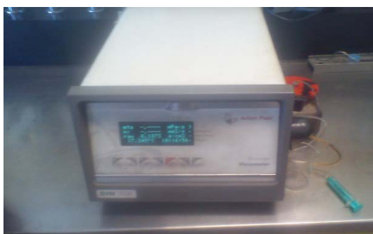
Figura 14. Viscosímetro SVM 3000 Stabinger
