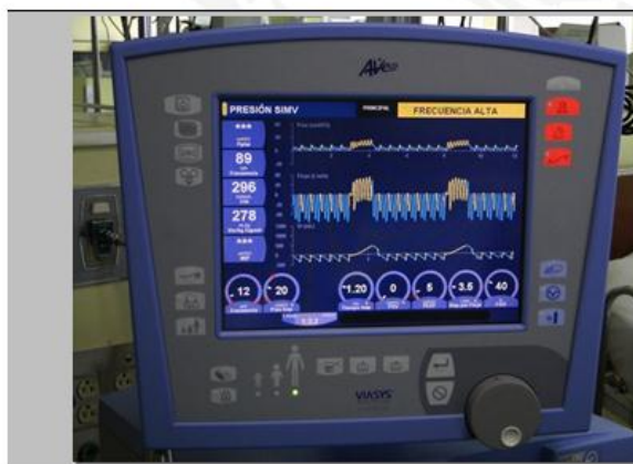
Ilustración 10.1 Se identifica la pantalla clásica que caracteriza al ventilador AVEA, donde se ven los modo en que pueden conectarse, ya sea neonatal, pediátrico o adulto.
