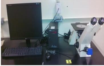
El microscopio óptico permitió observar los nódulos y la microestructura del hierro antes y después de tratamiento térmico de austemperizado.
