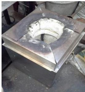
En el horno para austenizado se fundió una sal la cual, nos permitió austenizar las piezas de tensión, impacto y dureza en un rango de temperatura de 850 y 900°C.
