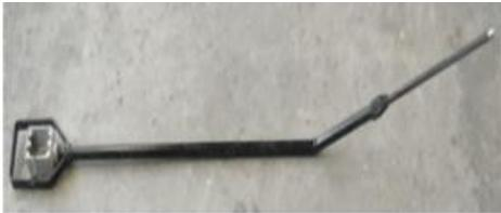
El termopar de inmersión tipo R/S fue usado para medir temperaturas que se encontraban alrededor de los 1450°C dentro del baño metálico.
