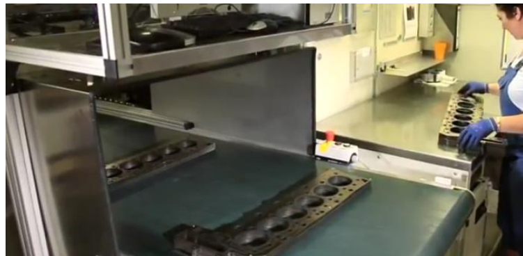
Figura III.22.- Junta de cabeza totalmente recubierta y libre de residuos.
