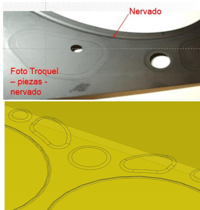
Figura III.12.- Diseño actual de dados de nervado [III.5].
