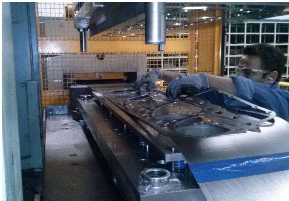
Figura III.17.- Proceso de Punzonado de Juntas tipo MLS.
