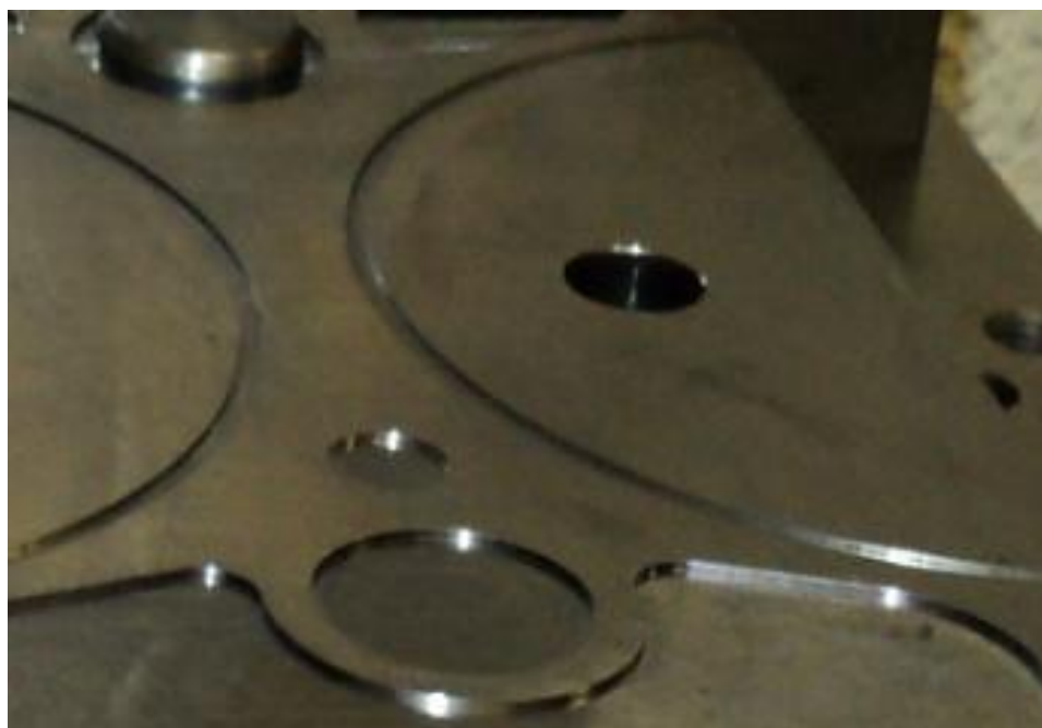
Figura III.18a.- Forma de los dados de nervado sin ángulos en los bordes.
