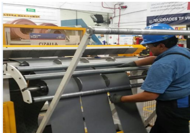
Figura III.16.- Sliteado de la lámina de acero inoxidable.
