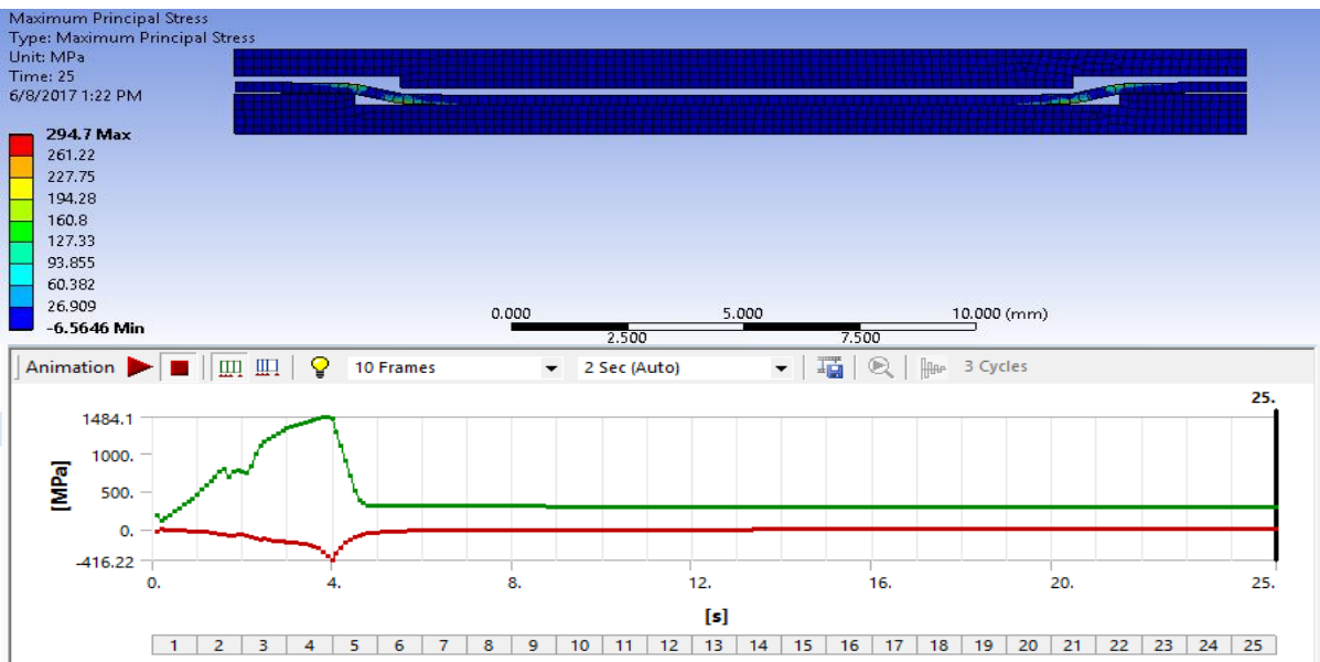
Figura IV.24.- Esfuerzos equivalentes (Von Mises).
