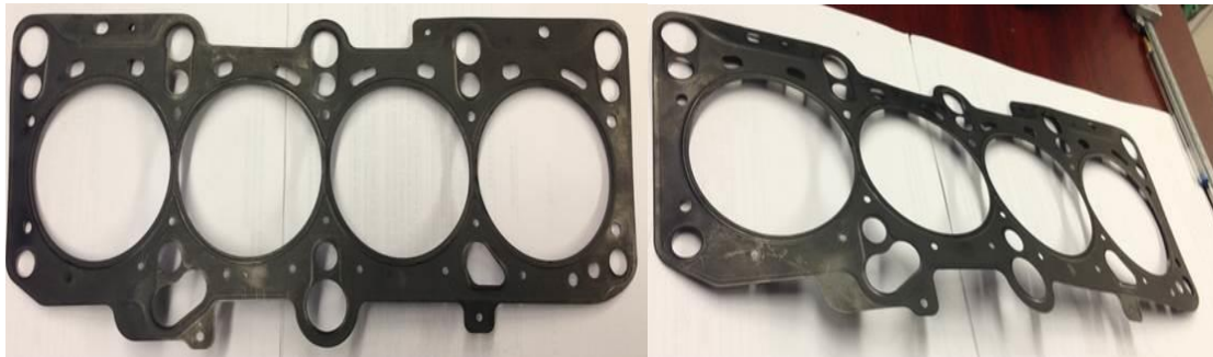
Figura III.14.- Deformación de junta después de nervado [III.5].
