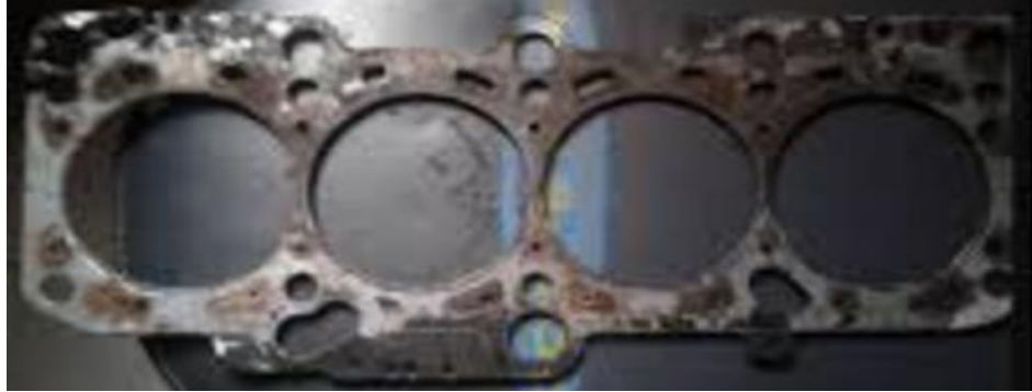
Figura III.13.- Corrosión en una Junta MLS [III.5].
