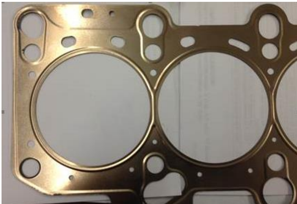
Figura III.18.- Proceso de nervado en Junta tipo MLS sin recubrimiento.
