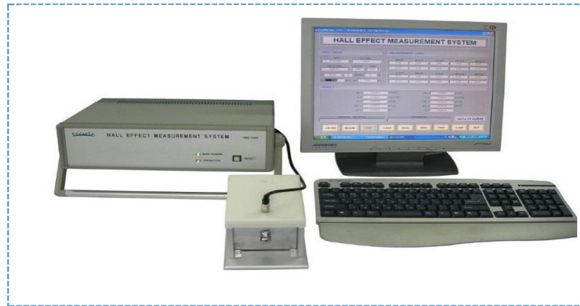
Figura 19. Equipo de medición por efecto hall (CICATA IPN Unidad Legaría)
