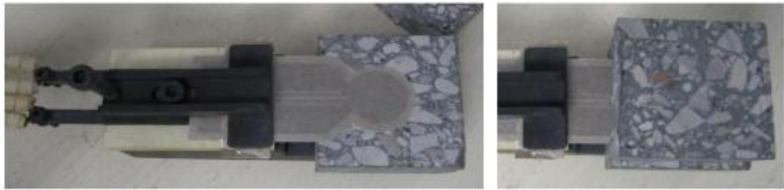
Figura 1. Ilustración del sensor de mica en el ensayo de propiedades térmicas.
